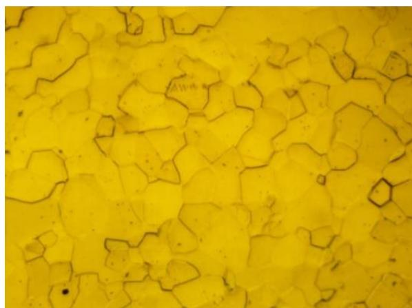
Технически чистый титановый  $\alpha$  – сплав BT1-0
