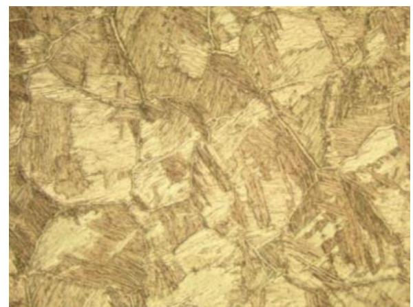
Титановый ( $\alpha+\beta$ ) – сплав
