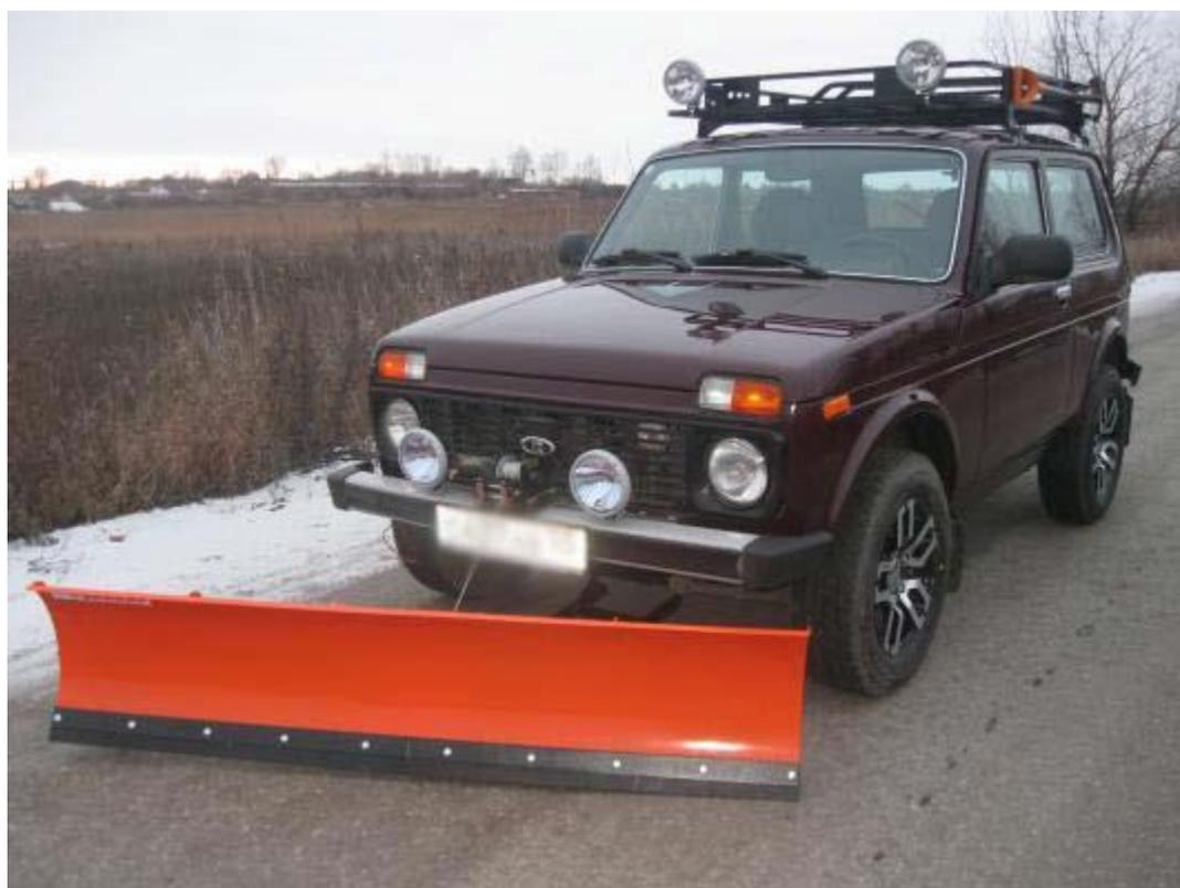
Рисунок 3 - Отвал для автомобиля лада 4x4, ООО «Вамер», г.Тольятти, Самарская область
