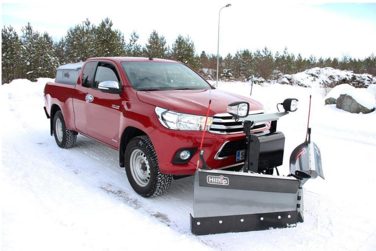
Рисунок 4 – Отвал HILLTIP SNOW STRIKER V-PLOW для TOYOTA HILUX
