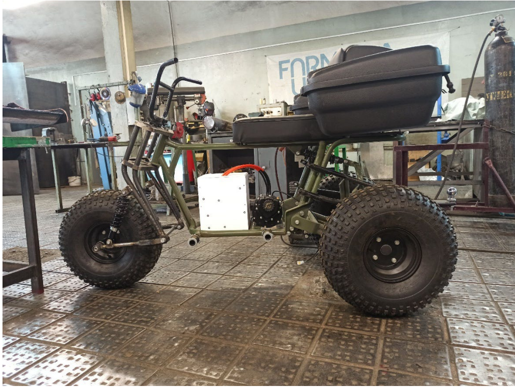
Рисунок 55 – Внешний вид электрического прототипа мотовездехода
