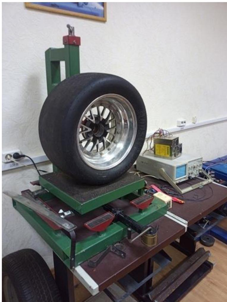
Рисунок 12 – Испытательный стенд для расчета коэффициента сцепления
