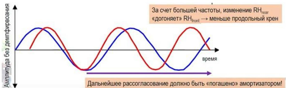
Рисунок 38 – График и колебаний передней и задней оси автомобиля
