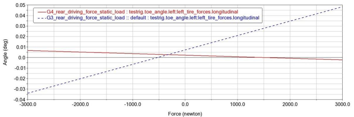
Рисунок 64 – Изменение углов схождения на задней оси при силе, возникающей во время движения
