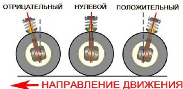
Рисунок 19 – Положительный, отрицательный и вертикальный углы кастера
