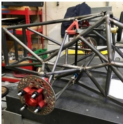
Рисунок 1 – Передняя подвеска с системой Push rod
