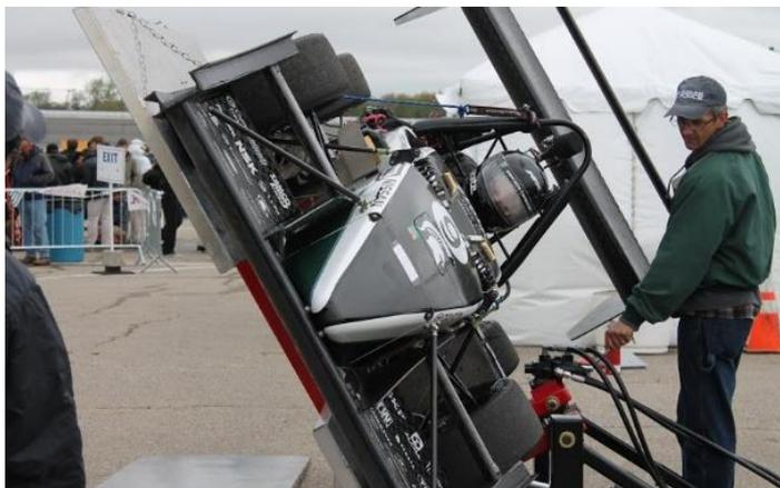
Рисунок 29 – Тест на наклонном столе
