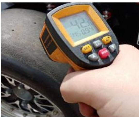
Рисунок 45 – Измерение температуры шин после проведения тестовых заездов
