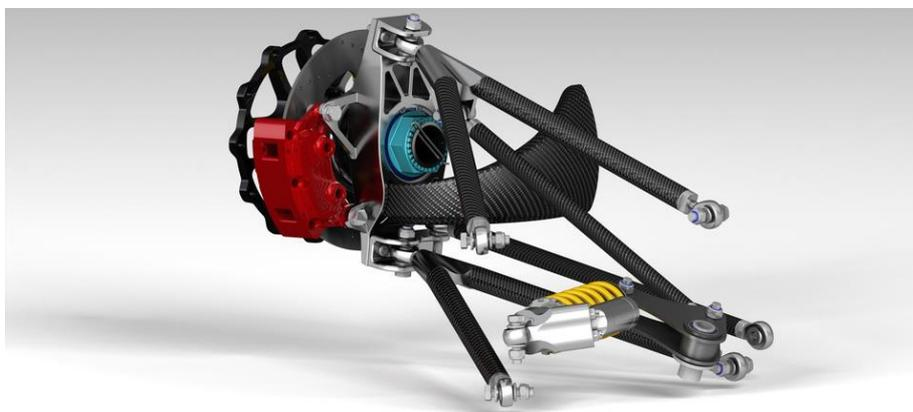
Рисунок 2 – Передняя подвеска с системой Pull rod
