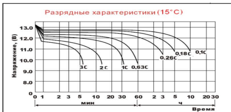
Рисунок 7 – График разрядных характеристик аккумуляторов фирмы Дельта номинальная емкость приведена для 10ч разряда.
