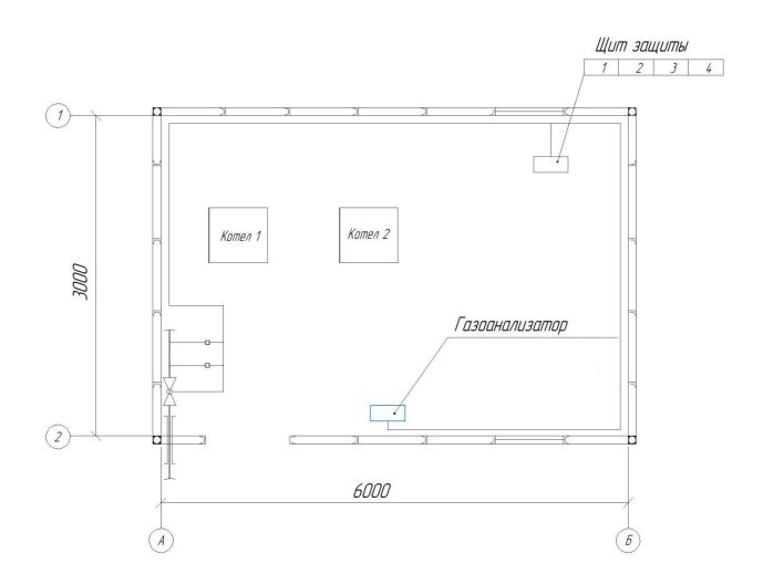
Рисунок 2 – Места установки газоанализатор NDIR серии S700 SICK МАІНАК в помещениях котельной АО «УПНП и КРС»
