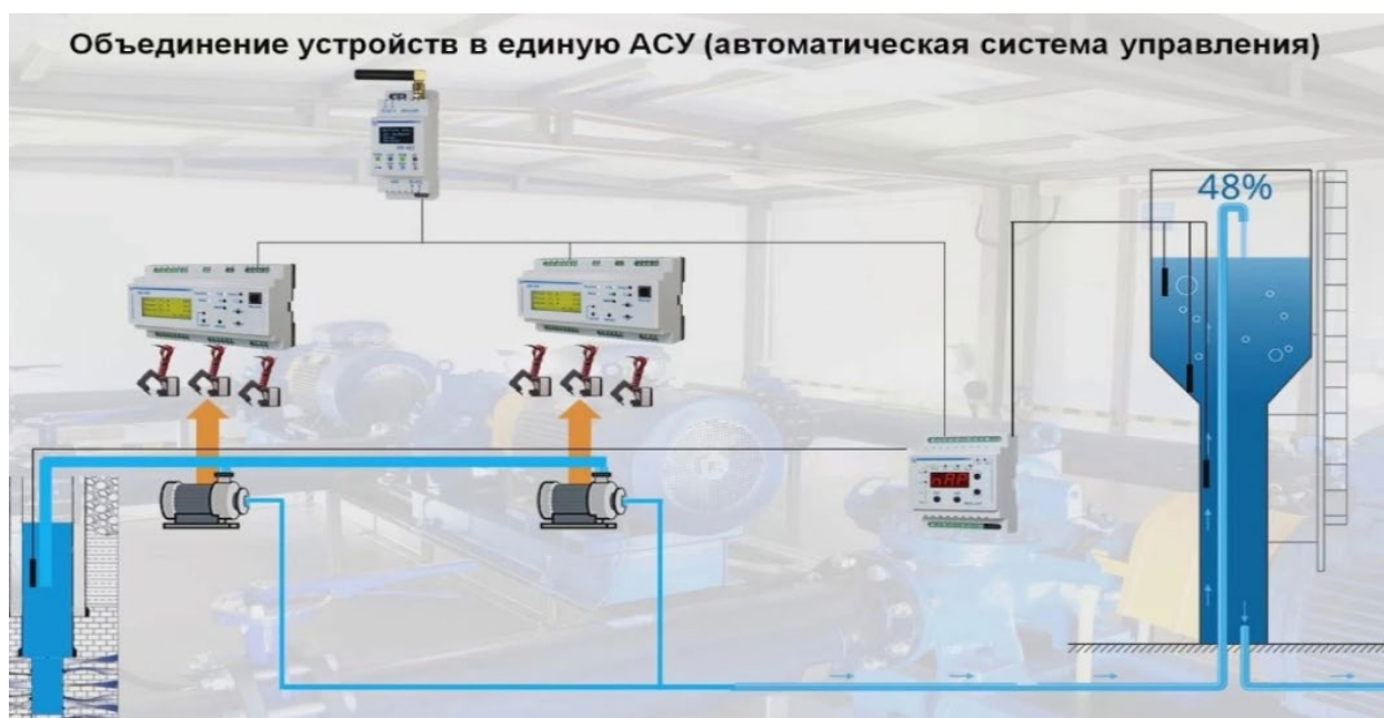
Рисунок 17 – Схема автоматизации подъема воды и объединения устройств в единую АСУ
