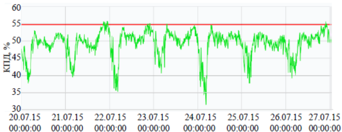
Рисунок 20 – График изменения коэффициента полезного действия повысительной насосной станции
