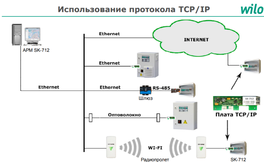
Рисунок 29 – Пример диспетчеризации насосного оборудования под управлением приборов Wilo
