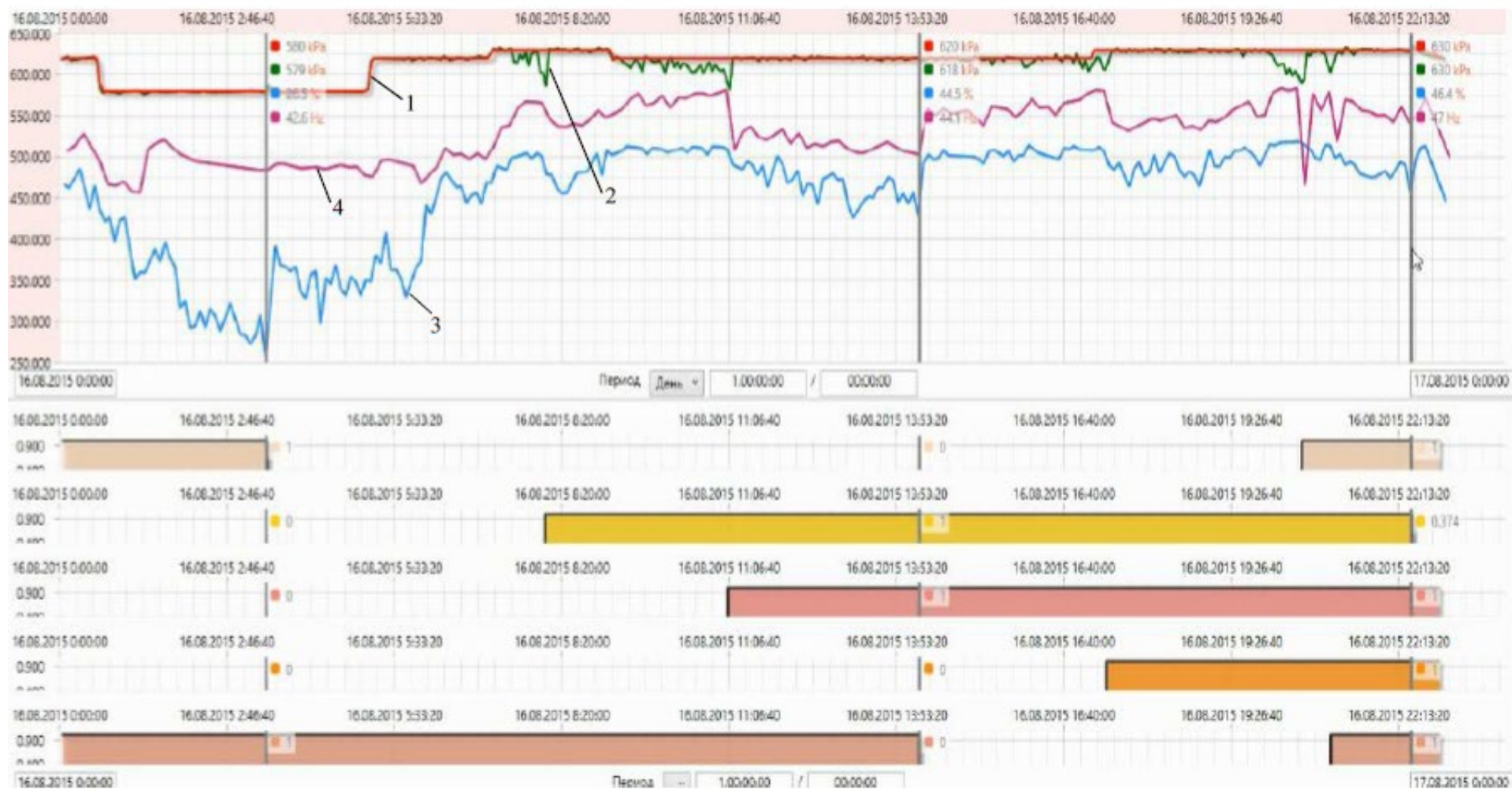
Рисунок 22 – Изменение коэффициента полезного действия насосной станции при отключении неэффективного насосного агрегата: 1 – заданное выходное давление; 2 – фактическое выходное давление; 3 – КПД насосной станции; 4 – частота регулируемого насоса
