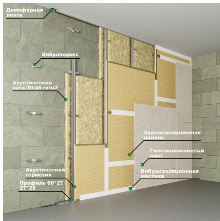
Рисунок 9 – Конструкция внутренней стены АБК
