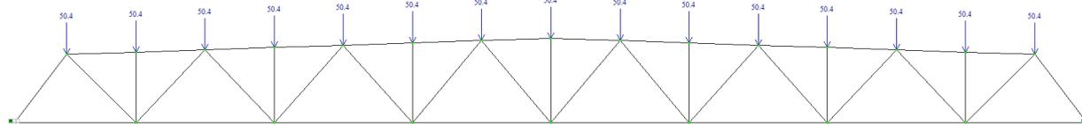
Рисунок 6 – Нагрузка от веса снегового покрова
