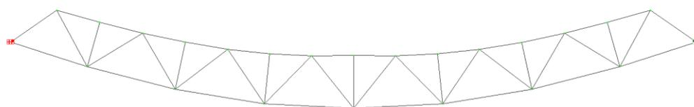
Рисунок 7 – Деформированная схема фермы под нагрузками
