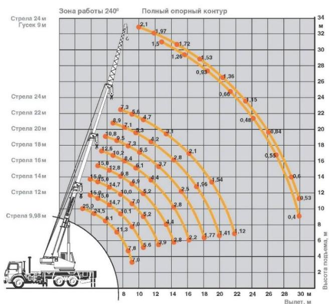
Рисунок 11 – Грузовая характеристика автокрана стрелового крана ДЭК-401
