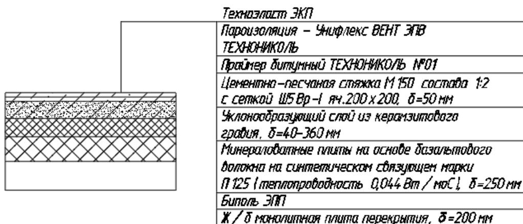
Рисунок 15 – Состав кровли
