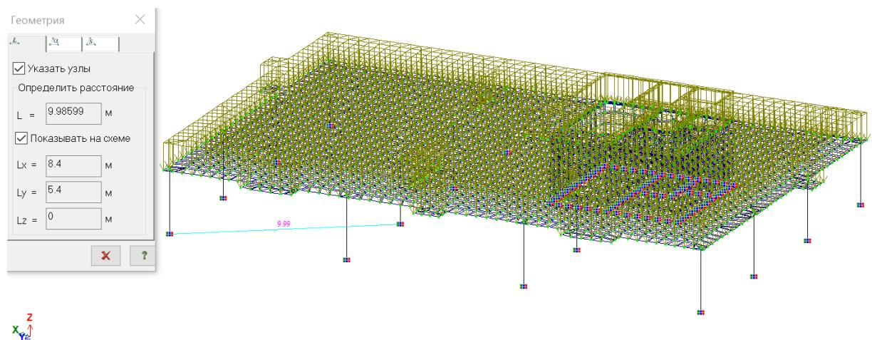
Рисунок Б.8 – Пролет с максимальным прогибом
