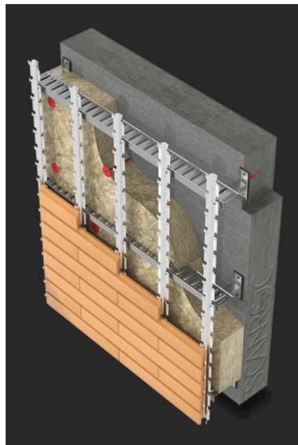
Рисунок А.1 – Схема навесной вентилируемой системы «Сканрок»
