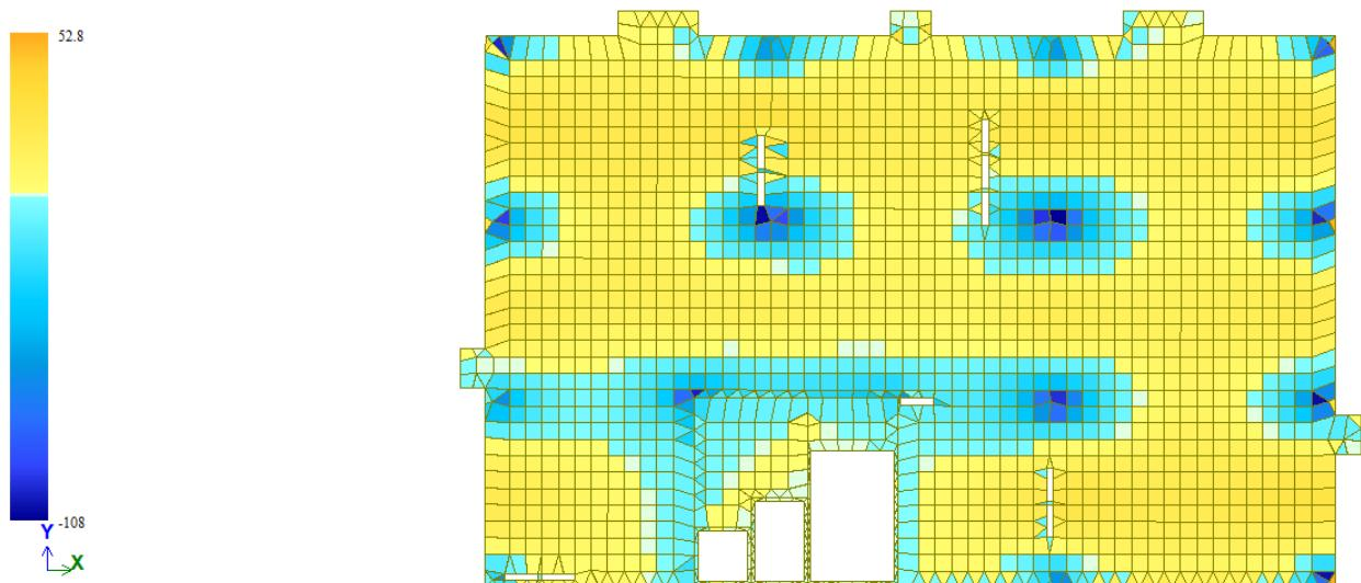
Рисунок Б.5 – Изгибающий момент по оси Х
