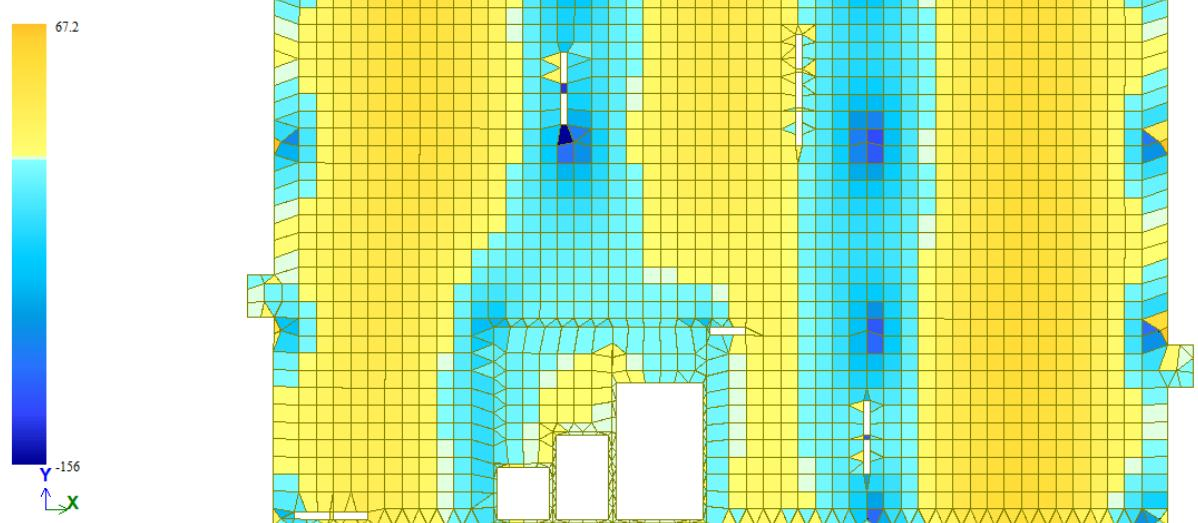
Рисунок Б.6 – Изгибающий момент по оси Y
