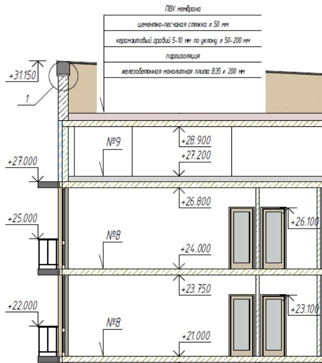
Рисунок В.1 – Конструктивное решение кровли
