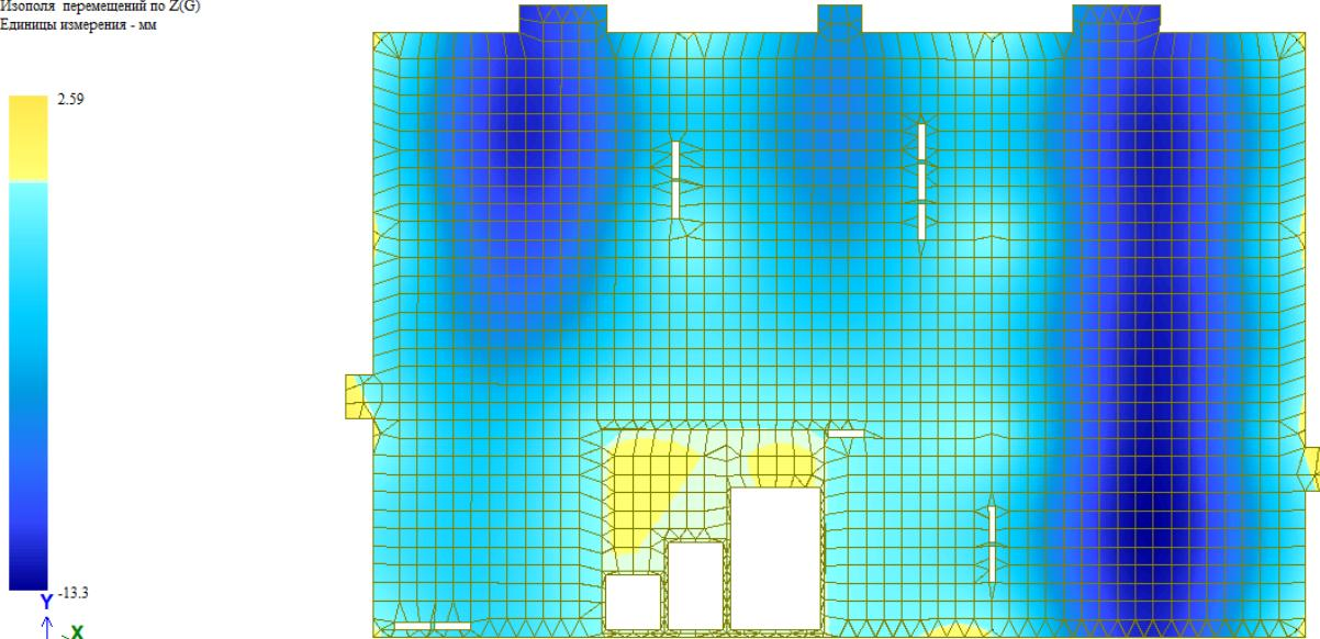
Рисунок Б.4 – Прогибы плиты перекрытия от нормативной нагрузки
