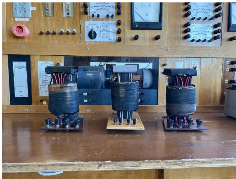
Рисунок 22 – Ранжированная группа трансформаторов
