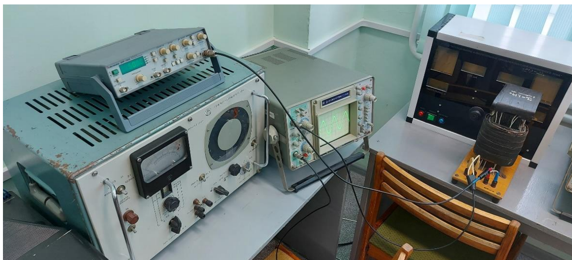
Рисунок 16 – Испытательный стенд, используемый в эксперименте и также для снятия характеристик трансформатора
