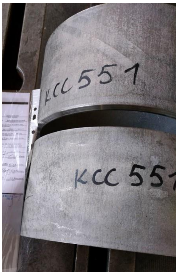
Рисунок 13 – Сварной образец из сплава 10ХН45Ю
