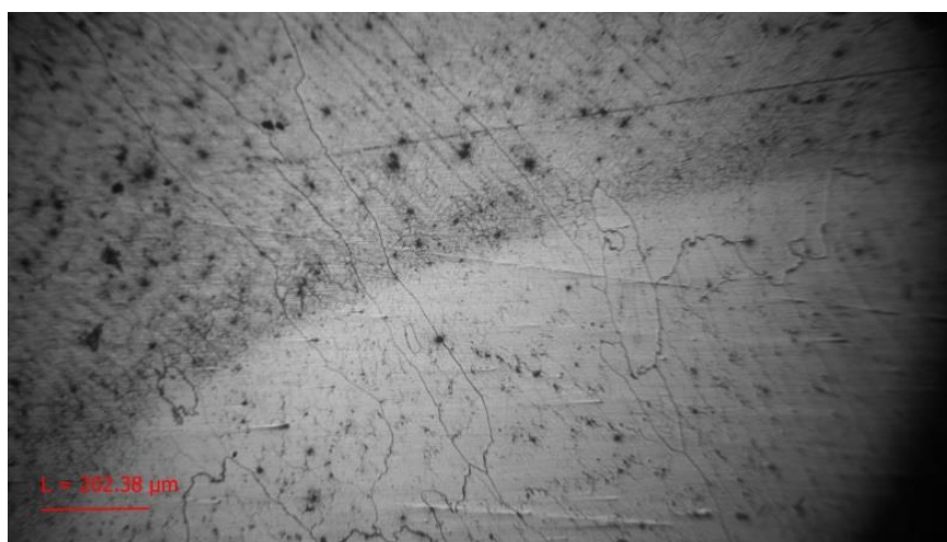
Рисунок 36 – 300-кратное увеличение образца варианта 1, сварной шов (зона сплавления)
