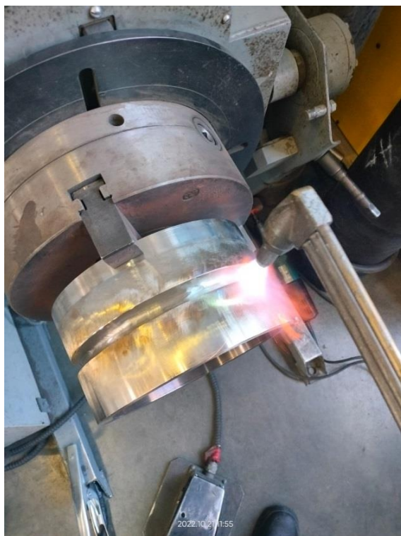
Рисунок 8 – Предварительный и сопутствующий подогрев сварного шва
