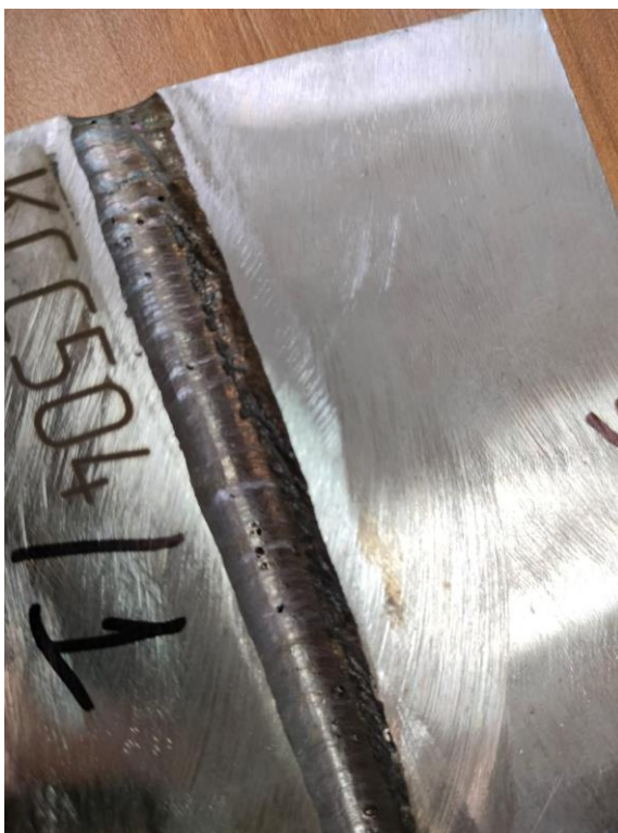
Рисунок 4 – Пористость внутри сварного шва
