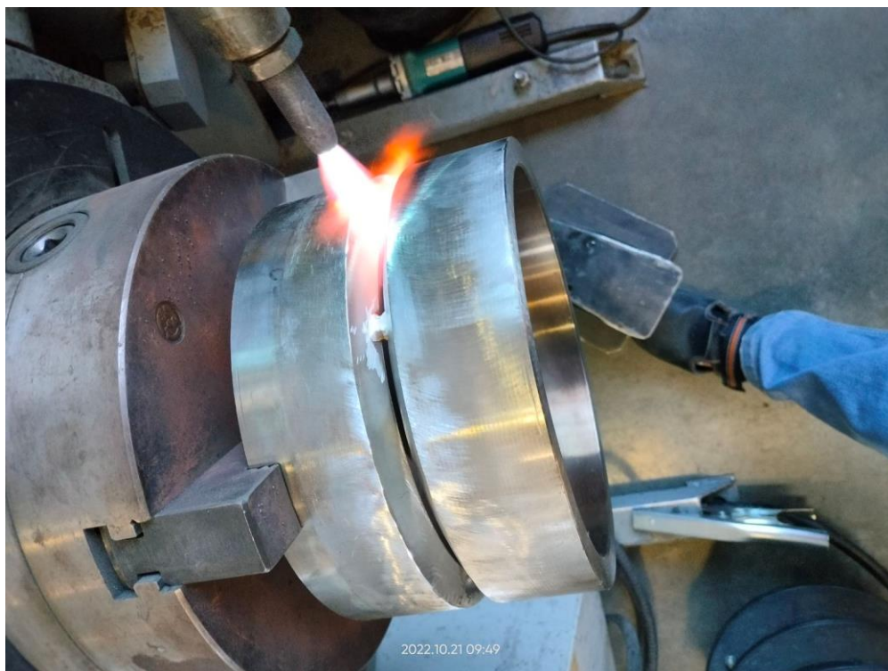
Рисунок 16 – Предварительный и сопутствующий подогрев кислородно-пропановым пламенем
