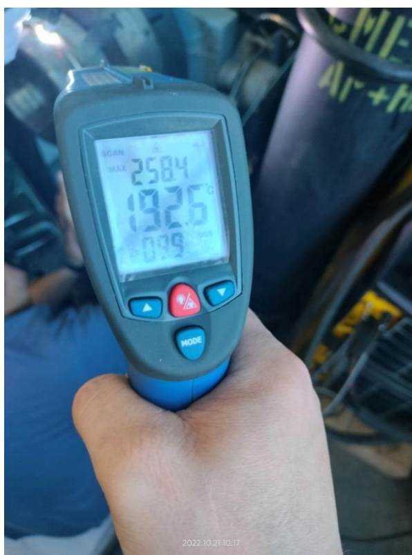
Рисунок 16 – Предварительный и сопутствующий подогрев кислородно-пропановым пламенем
