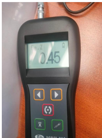
Рисунок 28 – Прибор многофункциональный вихретоковый МВП-2М, преобразователь Ф010
