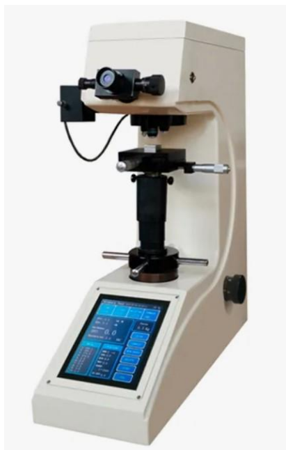
Рисунок 23 – Твердомер ИТВ, модификация ИТВ-30-II-AЖ
