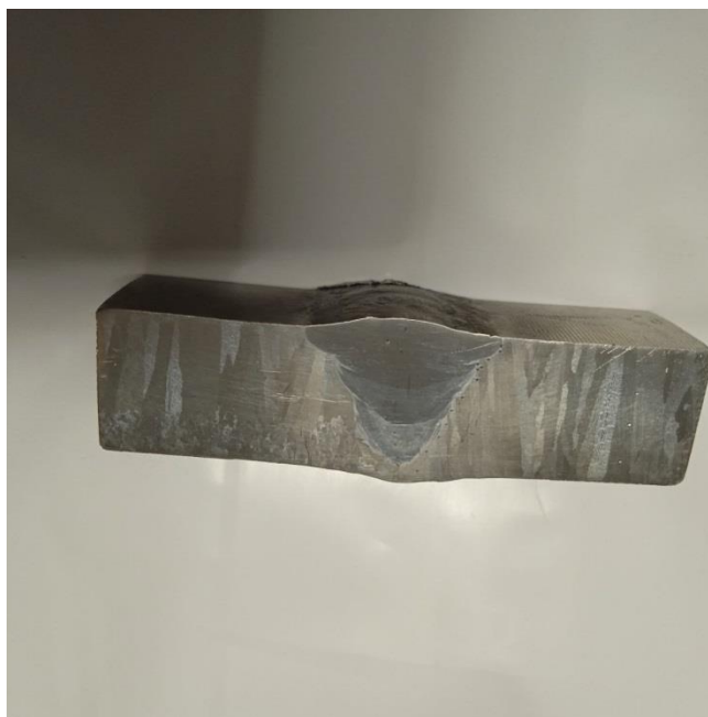
Рисунок 19 – Образец варианта 1 для исследования макроструктуры
