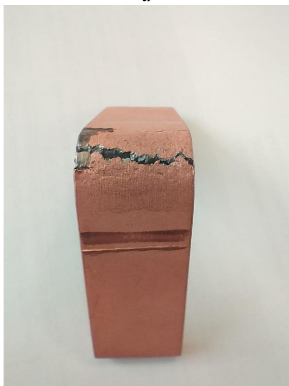
a – вариант 1; б – вариант 2 Рисунок 46 – Результаты испытания на стойкость против к МКК методом ВУ
