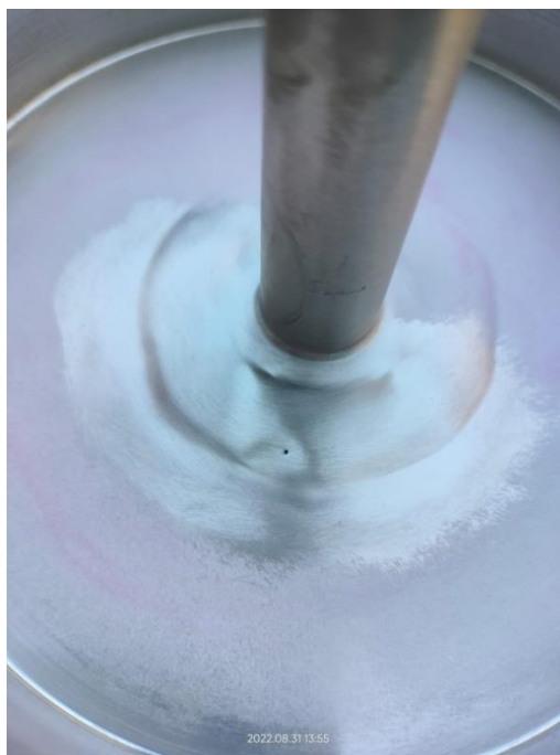
Рисунок 7 – Кратер сварного шва
