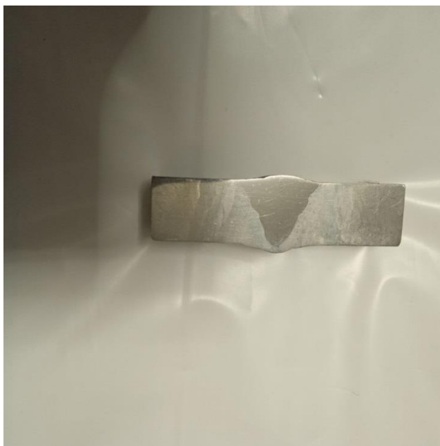
Рисунок 22 – Образец варианта 2 для исследования микроструктуры
