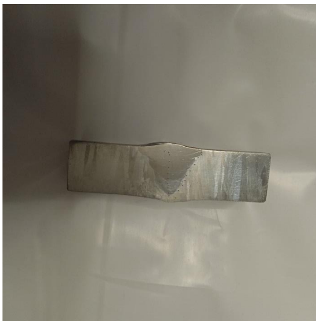
Рисунок 21 – Образец варианта 1 для исследования микроструктуры
