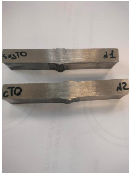
Рисунок 27 – Образцы для измерения СФФ
