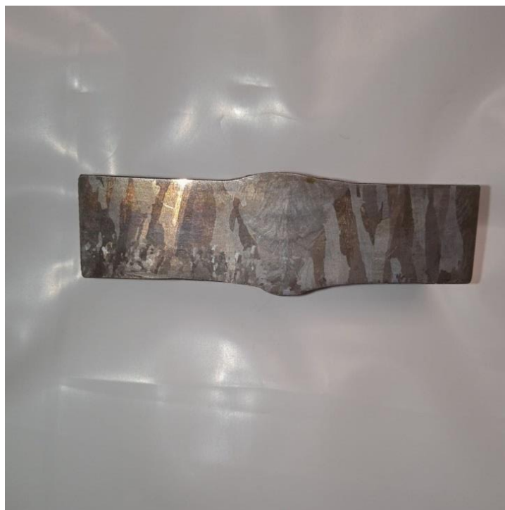
Рисунок 20 – Образец варианта 2 для исследования макроструктуры
