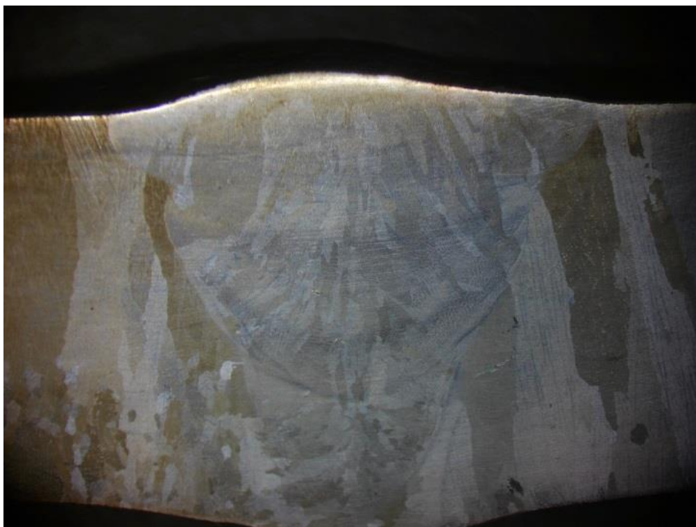
Рисунок 31 – Образец исследования макроструктуры варианта 2
