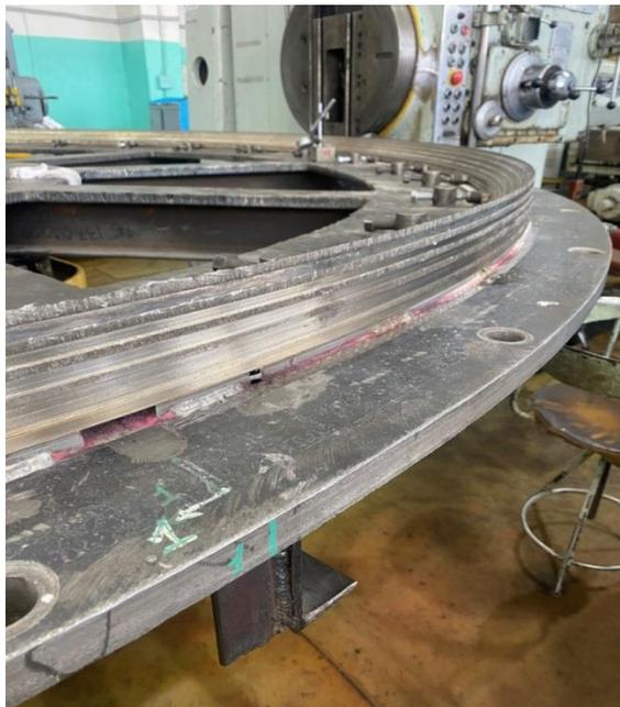
Рисунок 24 – Наплавленная внешняя поверхность после токарной обработки
