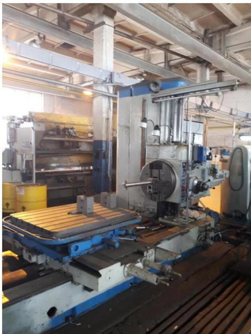
Рисунок 20 – Внешний вид горизонтально – расточного станка М2620
