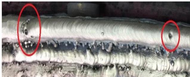
Рисунок 14 – Наплавка сварочной проволокой ДКРНТ 3,0 БТ НП-2
