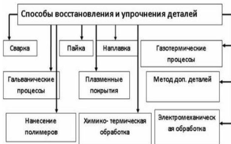
Рисунок 8 – Способы восстановления и упрочнения поверхностей деталей
