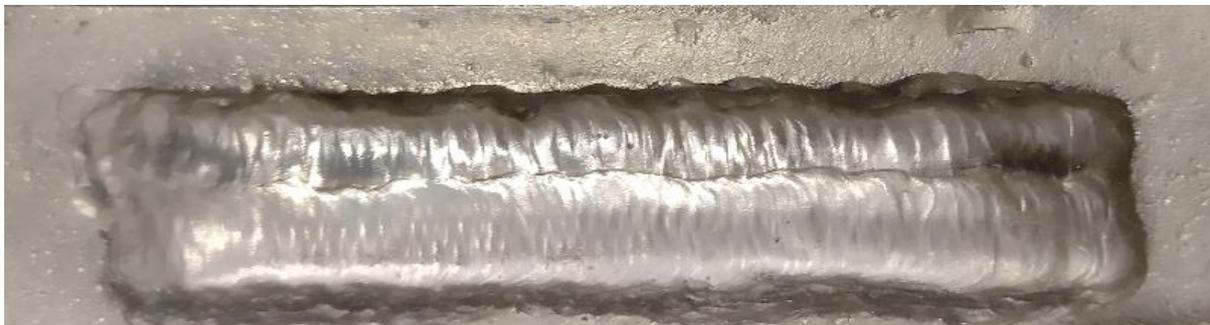
Рисунок 15 – Наплавка сварочной проволокой НМцАТ-3-1,5-06
