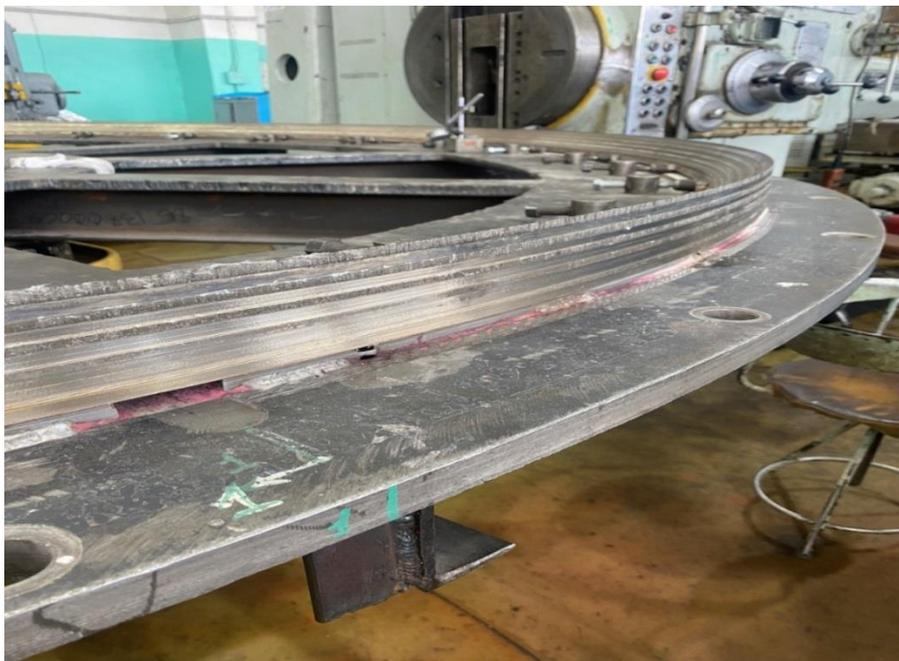
Рисунок 21 – Уплотнительное кольцо на станке M2620
