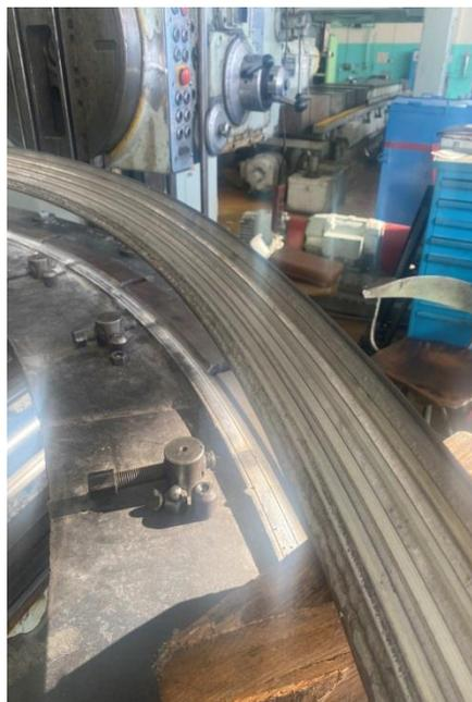
Рисунок 23 – Наплавленная внутренняя поверхность после токарной обработки
