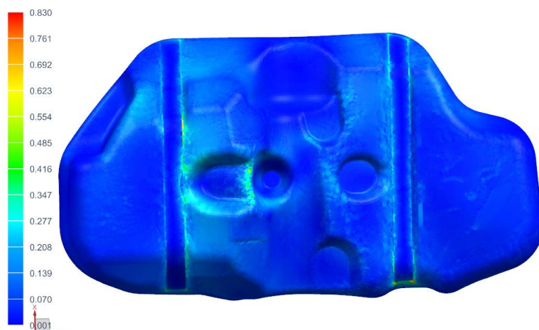
Рисунок 77 – Визуализация напряжений, возникающих в корпусе топливного бака (вариант без перегородки) при испытании на провисание
