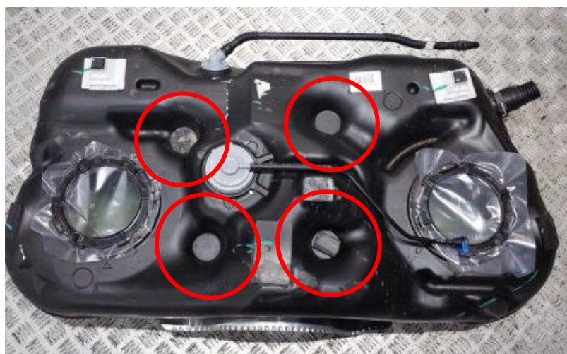
Рисунок 86 – Пример применения зон смыкания на корпусе топливного бака
