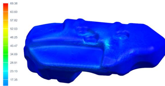
Рисунок 71 – Визуализация напряжений, возникающих в корпусе топливного бака (вариант с перегородкой) при гидравлическом испытании
