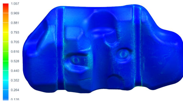
Рисунок 75 – Визуализация напряжений, возникающих в корпусе топливного бака (вариант с перегородкой) при испытании на провисание
