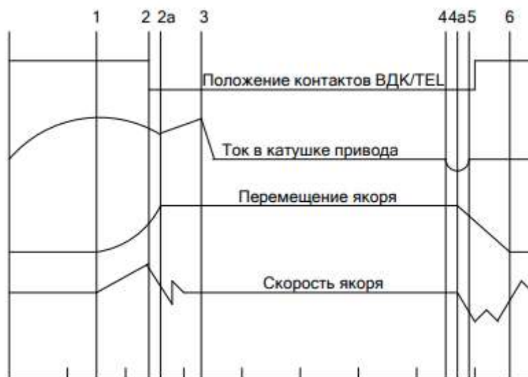
Рисунок 12 – Осциллограммы работы коммутационного модуля в цикле В-О
