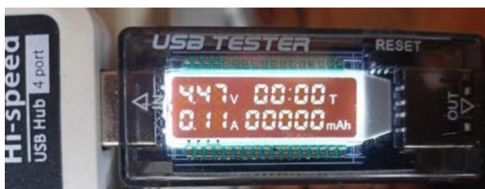
Рисунок 14 – Измерение токового потребления собранной схемы
