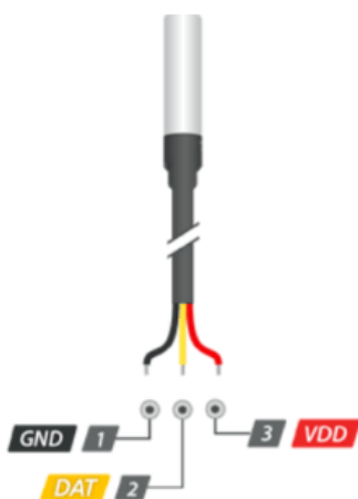
Рисунок 5 – Датчик температуры DS18B20 и его выводы
