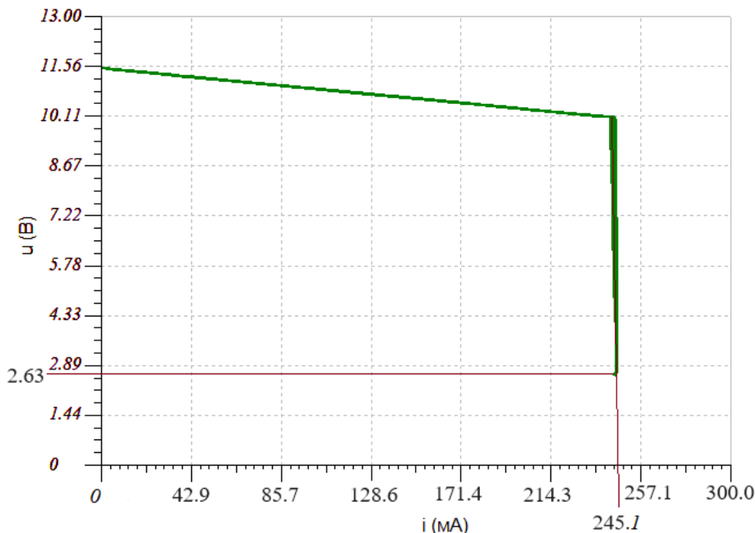
Рисунок 14 – ВАХ каскада ограничения по силе тока
