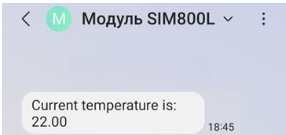
Рисунок 4.5 – Принятая СМС, оповещающая о текущей температуре по запросу в виде входящего звонка.
