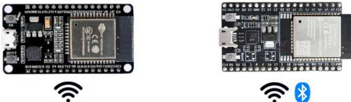
Рисунок 8 – Микроконтроллеры ESP8266 и ESP32
