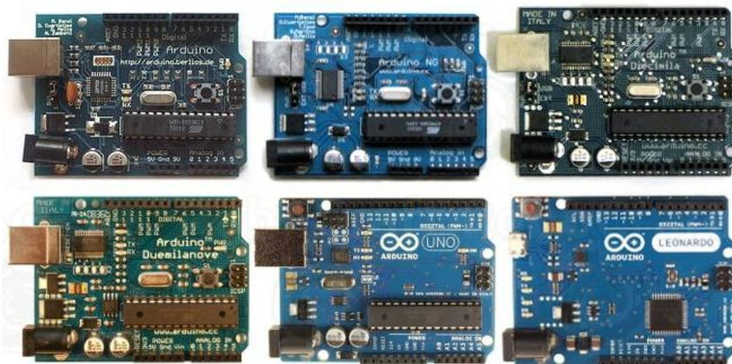
Рисунок 6 – Разновидности плат Arduino
