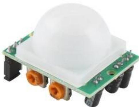
Рисунок 11 – PIR датчик движения
