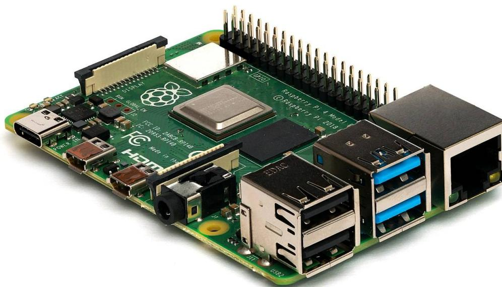
Рисунок 7 – Raspberry Pi 4 Model B from the side
