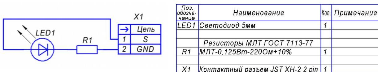
Рисунок 15 – Принципиальная схема светодиодного модуля
