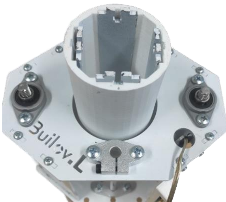
Рисунок 40 – Выдвижной пин обнулен в конечном положении
