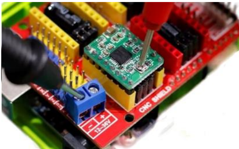
Рисунок 43 – Установка опорного напряжения на драйвере A4988
