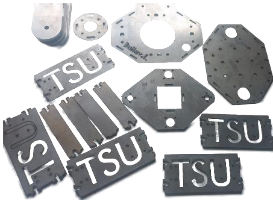
Рисунок 32 – Изготовленные детали зацепного устройства
