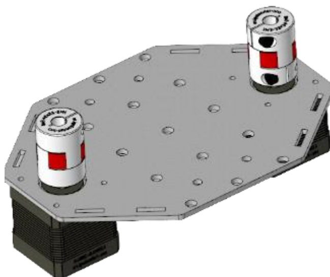
Рисунок 25 – Пластина основания с шаговыми двигателями
