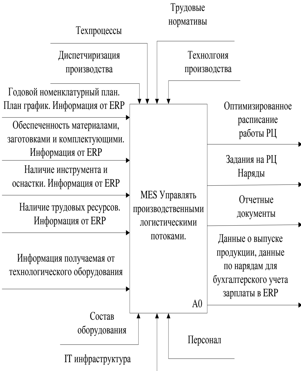
Рисунок 1.8 – Входные и выходные логистические потоки относительно логистической информационной системы MES
