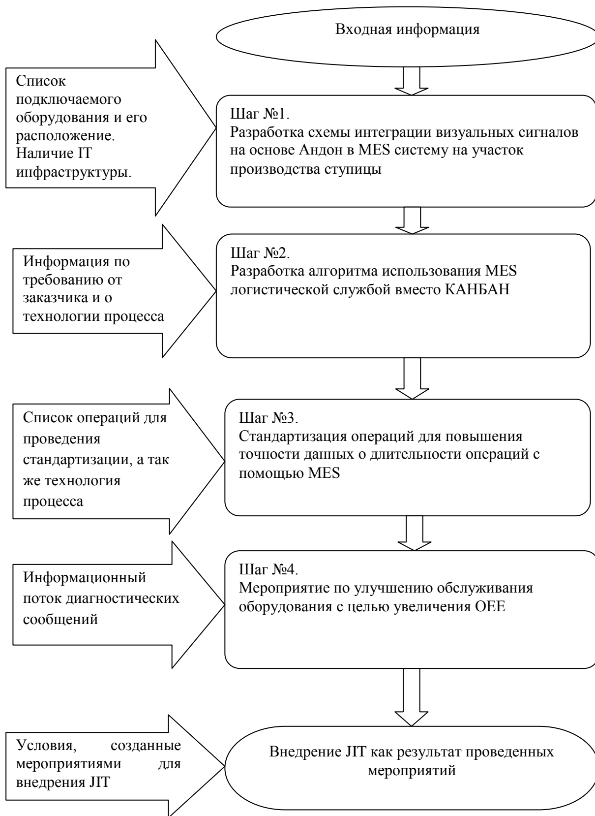
Рисунок 3.1 – Модель внедрения MES с учетом специфики осуществляемых процессов и требований заказчика, включающая в себя алгоритм использования MES.
