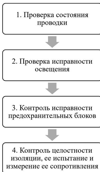
Рисунок 1 – Схема проверки осветительных приборов
