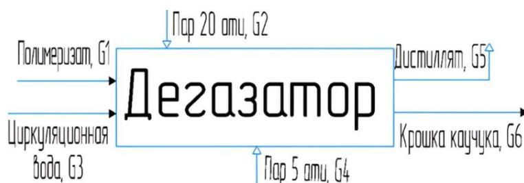
Рисунок 7 – Схема материального баланса
