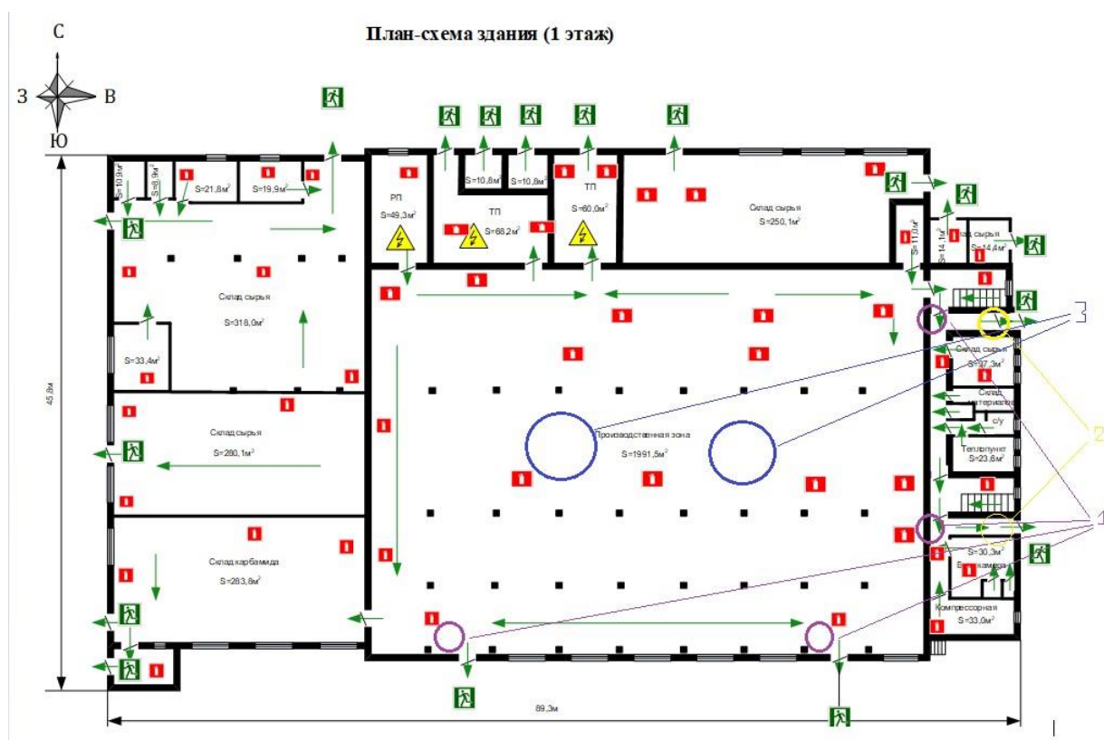
1 – контейнеры для сбора и обеззараживания использованных средств индивидуальной защиты, 2 – дезинфекционно-профилактической кабины, 3 – устройств полуоткрытого типа для обеззараживания воздуха в кондиционируемом помещении.
