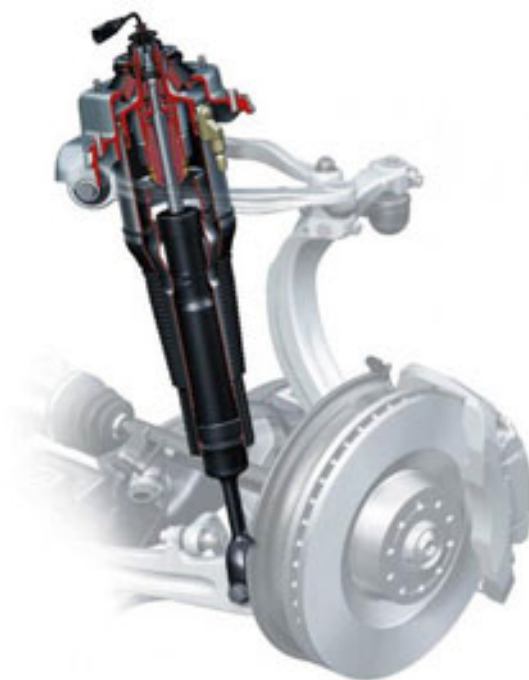
Рисунок 5– Передняя пневматическая подвеска
