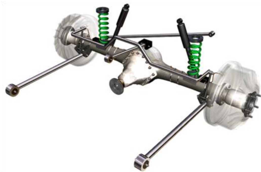
Рисунок 5 – Зависимая подвеска с тягой Панара
