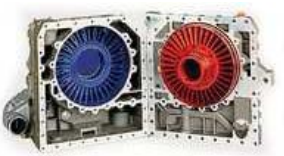
Рисунок 3 – Гидродинамический ретардер «в разрезе»
