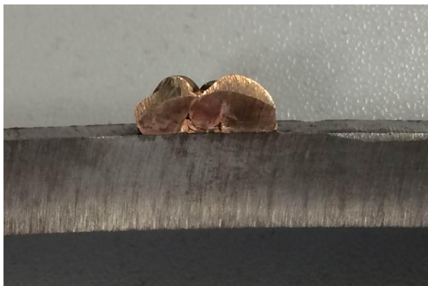
Рисунок 45 – Макроструктура дуговой наплавки (пайки) в среде аргона припоем на основе меди (сплав CuSi3), образец №2, x2,5
