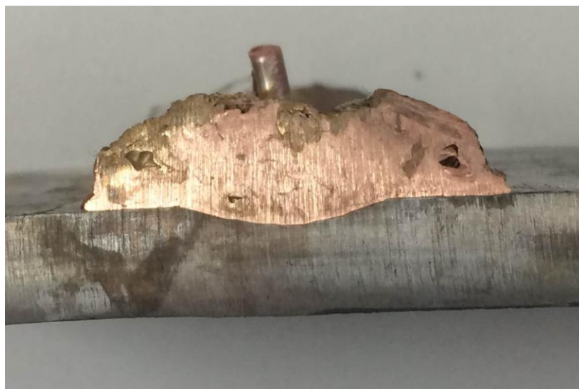
Рисунок 51 - Микроструктура наплавки термитной сваркой с использованием термокарандашей из прессованной медной термитной смеси в комплекте с многоразовыми графитовыми тигель-формами, образец №5, x2,0
