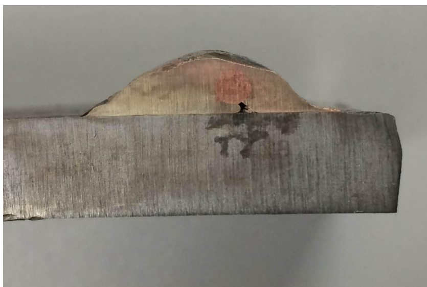
Рисунок 43 - Макроструктура дуговой наплавки (пайки) среде аргона припоем на основе меди (бронза Dt 2.1367), образец №1, x2,5
