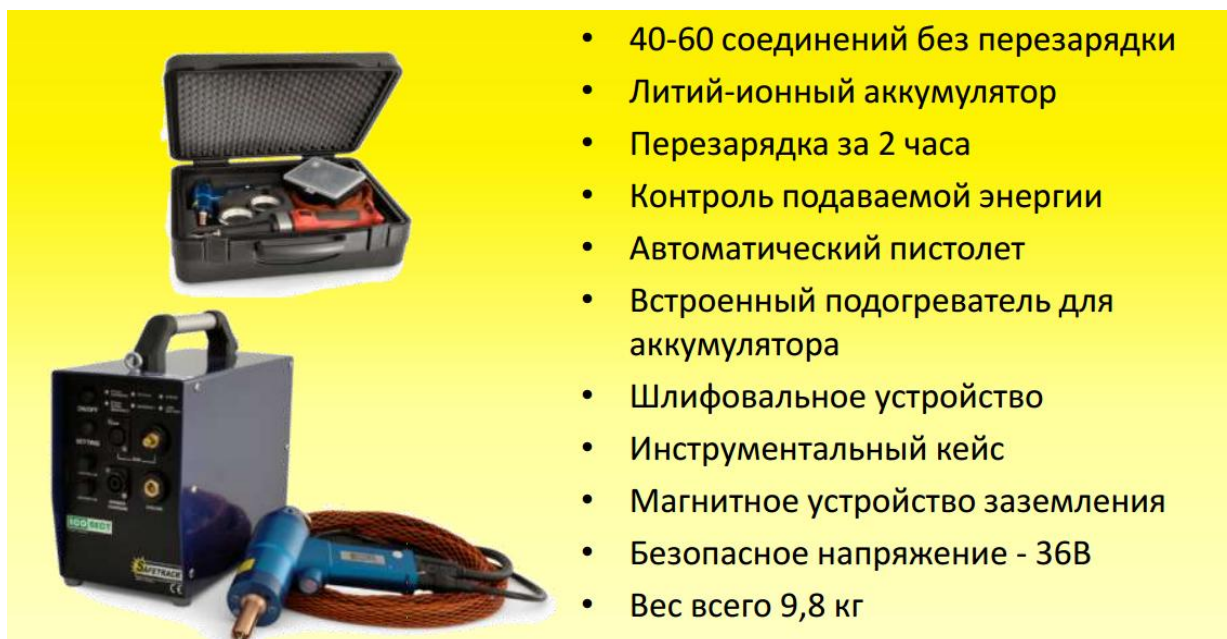
Рисунок 33 - Оборудование для штифтовой пайки.
