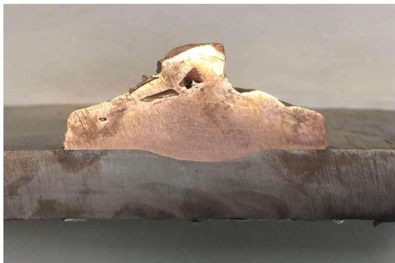
Рисунок 47 – Микроструктура наплавки термитной сваркой с использованием медных термитных смесей с одноразовой тигель-формой, образец №3, x2,0
