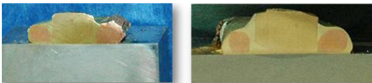
Рисунок 32- Микроструктура паяного соединения электрохимической защиты
