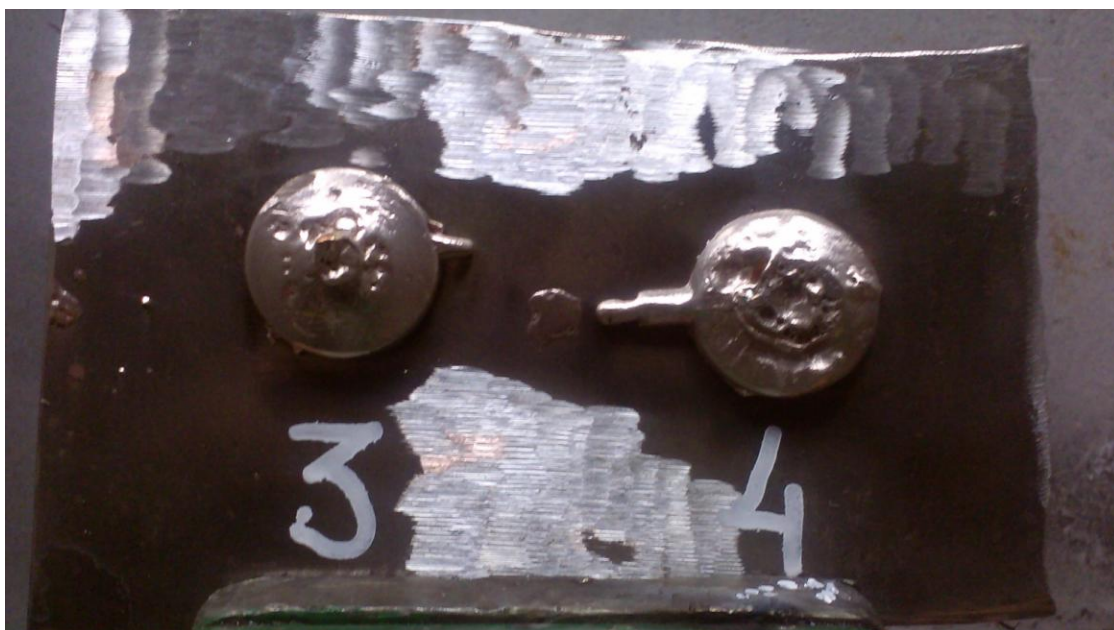
Рисунок 36 - Внешний вид образцов (вариант 3 и 4)
