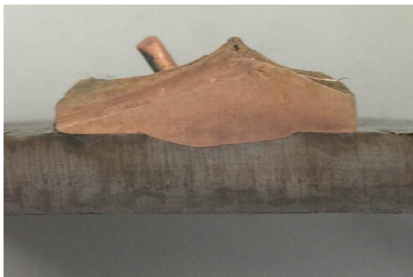
Рисунок 53 - Микроструктура наплавки термитной сваркой с использованием паяльно-сварочных стержней из медных термитных смесей в комплекте с многоразовыми графитовыми оправками, образец №6, х2,0
