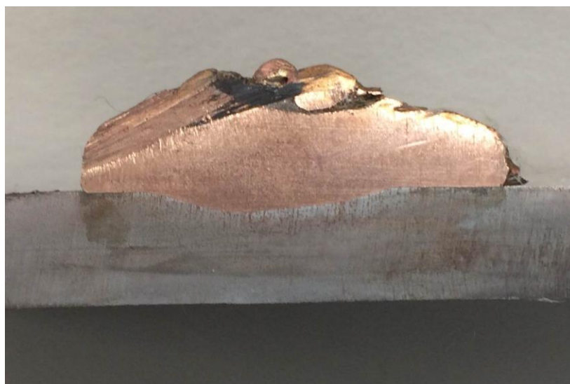
Рисунок 49 - Микроструктура наплавки термитной сваркой с использованием медных термитных смесей с многоразовой тигель-формой, образец №4, x2,0
