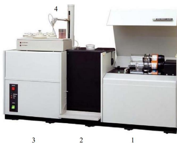
Рисунок 1 – Современный атомно-абсорбционный спектрометр: 1 – блок электроники и турель ламп с полным катодом; 2- пламенная горелка в защитном корпусе; 3 – блок обработки сигнала; 4 – автосамплер (устройство ввода проб) [6]
