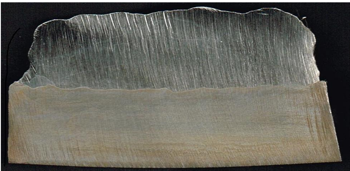
Рисунок 46 – Образец для исследования химического состава наплавки комбинацией дуг
