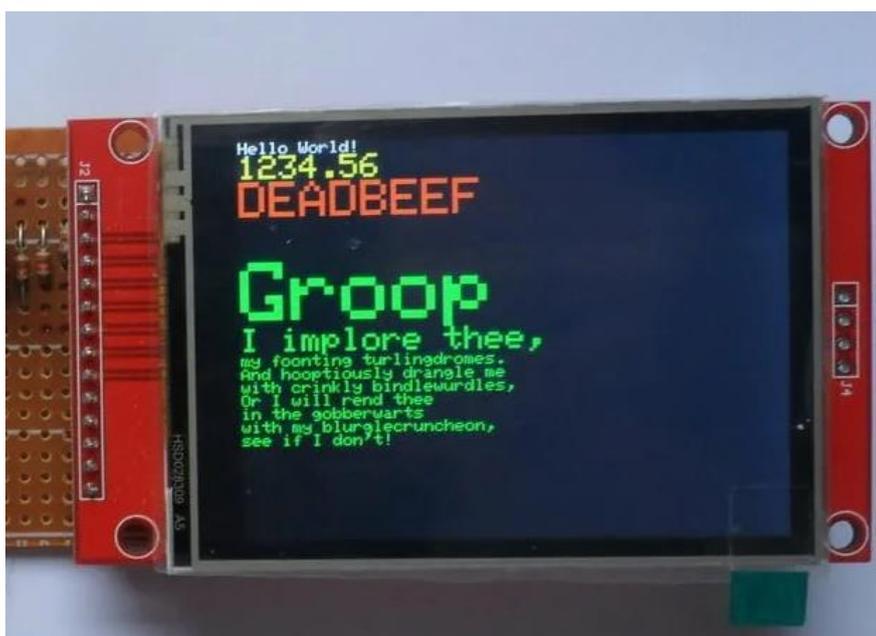
Рисунок 15 – TFT LCD на ILI9341
