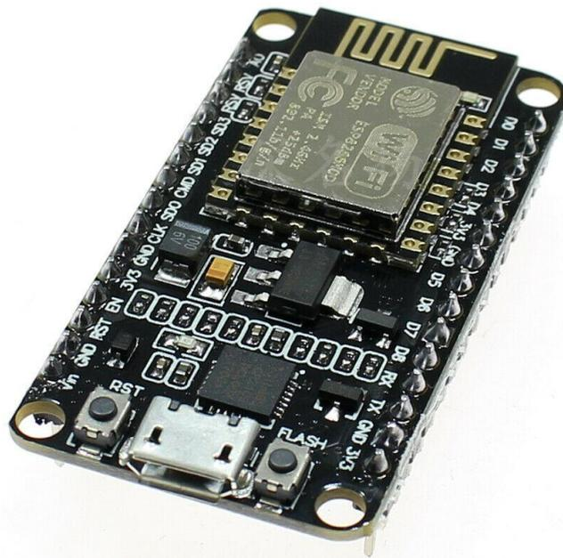
Рисунок 8 – Отладочная плата NodeMCU на базе ESP8266
