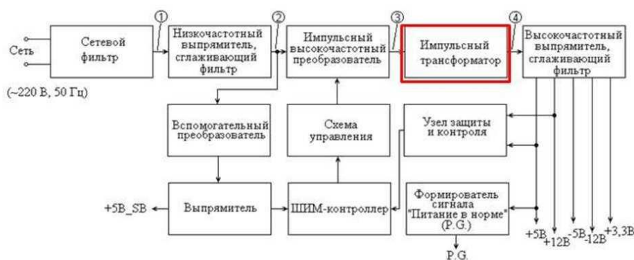
Рисунок 4 – Структура построения импульсных и трансформаторных блоков питания
