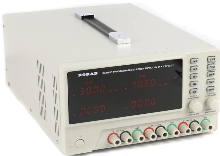
Рисунок 3 – 3х-канальный линейный лабораторный блок питания KORAD KA3305P
