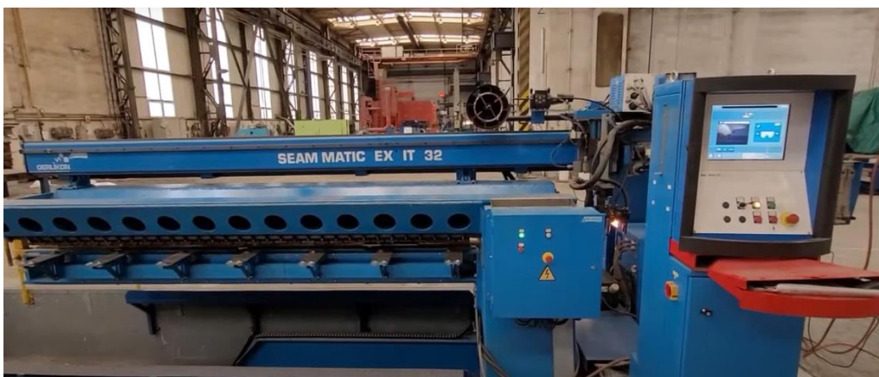
Рисунок 14- Сварочная установка для сварки продольных швов “Oerlikon”
