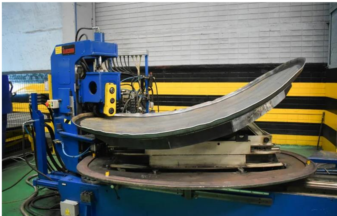
Рисунок 15 - Станок для фланжирования “Lucas RD 3800”
