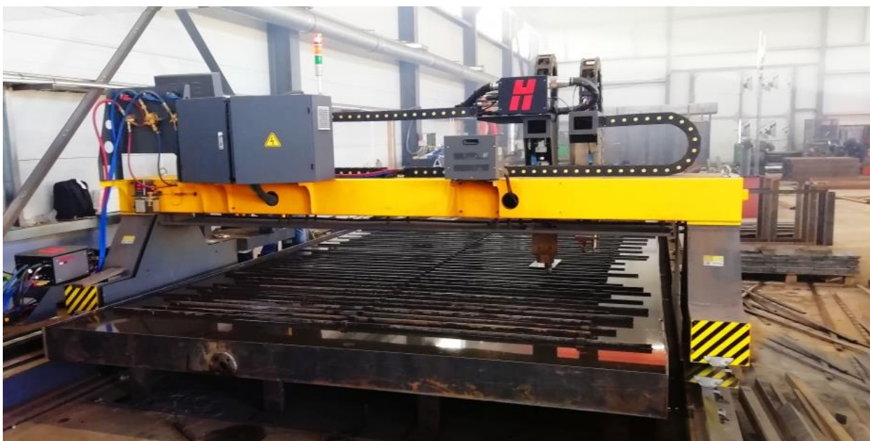
Рисунок 12- Станок плазменной резки Hgcut с источником плазмы Hypertherm XPR300
