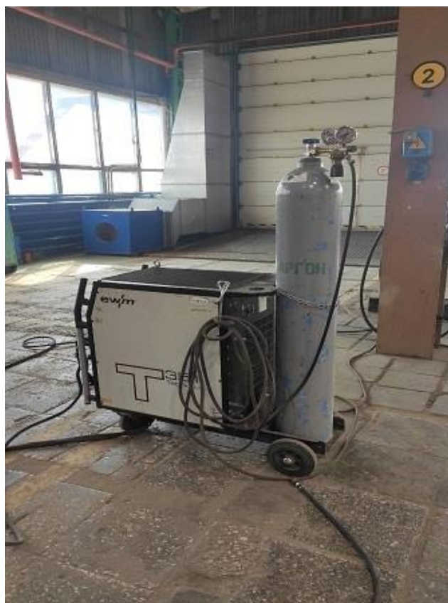
Рисунок 17 - Сварочная установка Tetrich 350AC/DC
