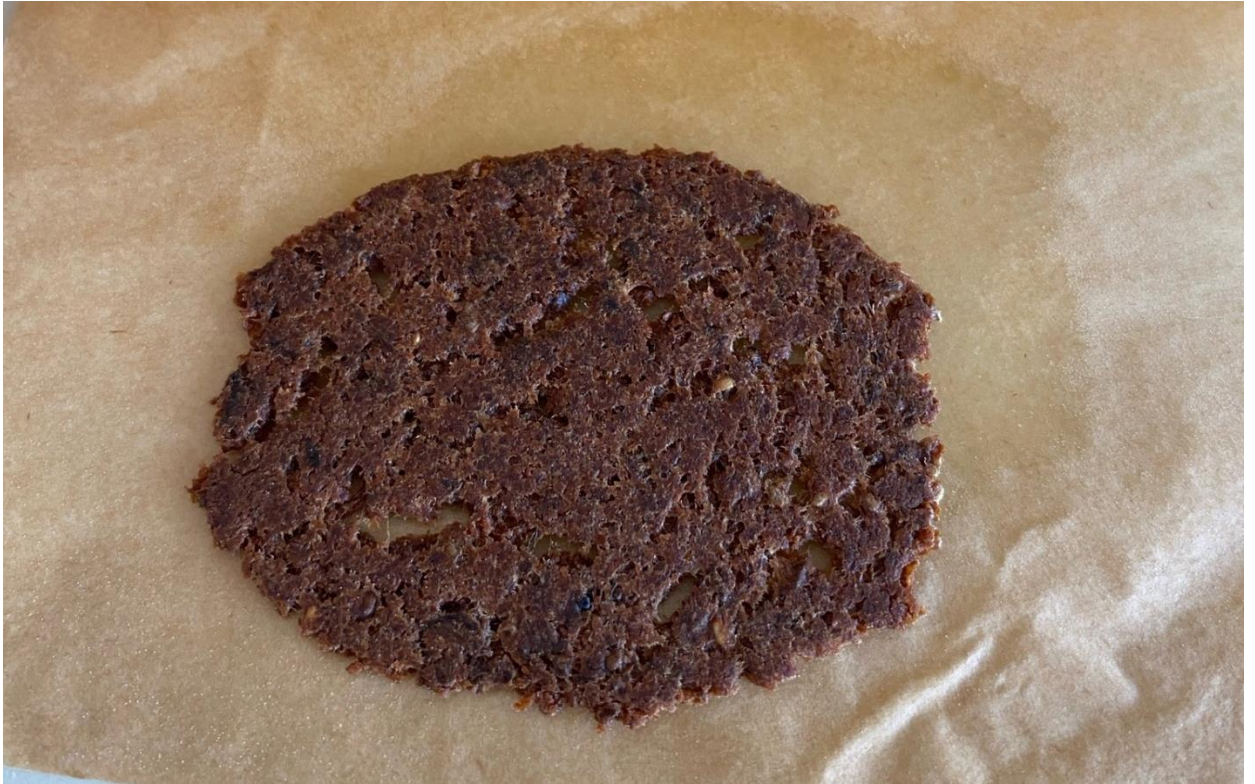
Рисунок И.5 – Анализ на содержание влаги. После высушивания образца хлеба из смеси гречневой и пшеничной муки
