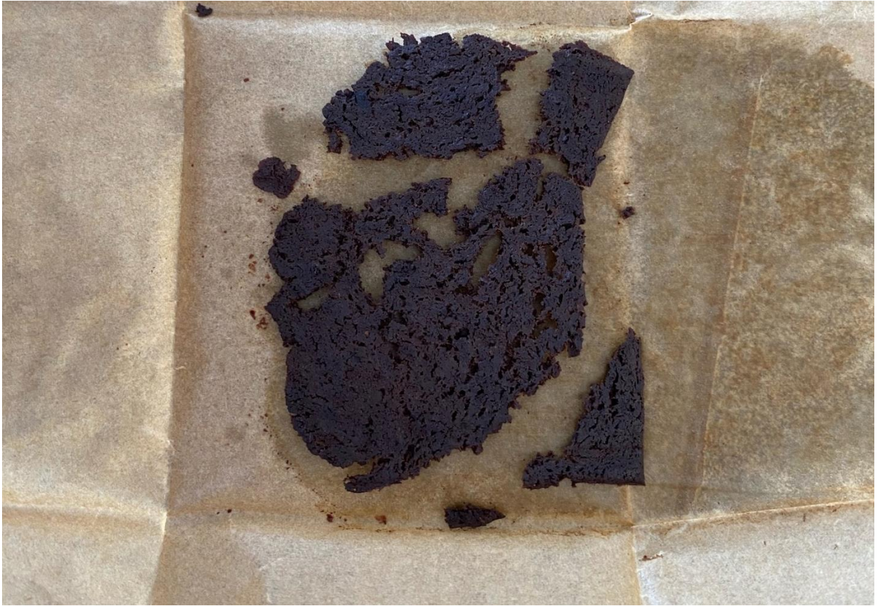
Рисунок 3.5 – Анализ на содержание влаги. После высушивания контрольного образца
