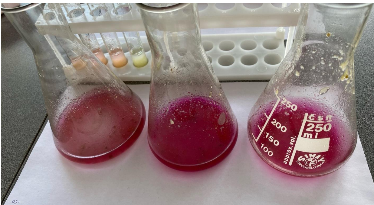
Рисунок Ж.4 – Результат титрования образца джема с добавлением 0,5 грамм аскорбиновой кислоты
