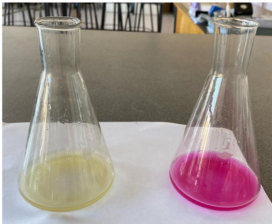
Рисунок 3.1 – Анализ на определение кислотности. До и после титрования
