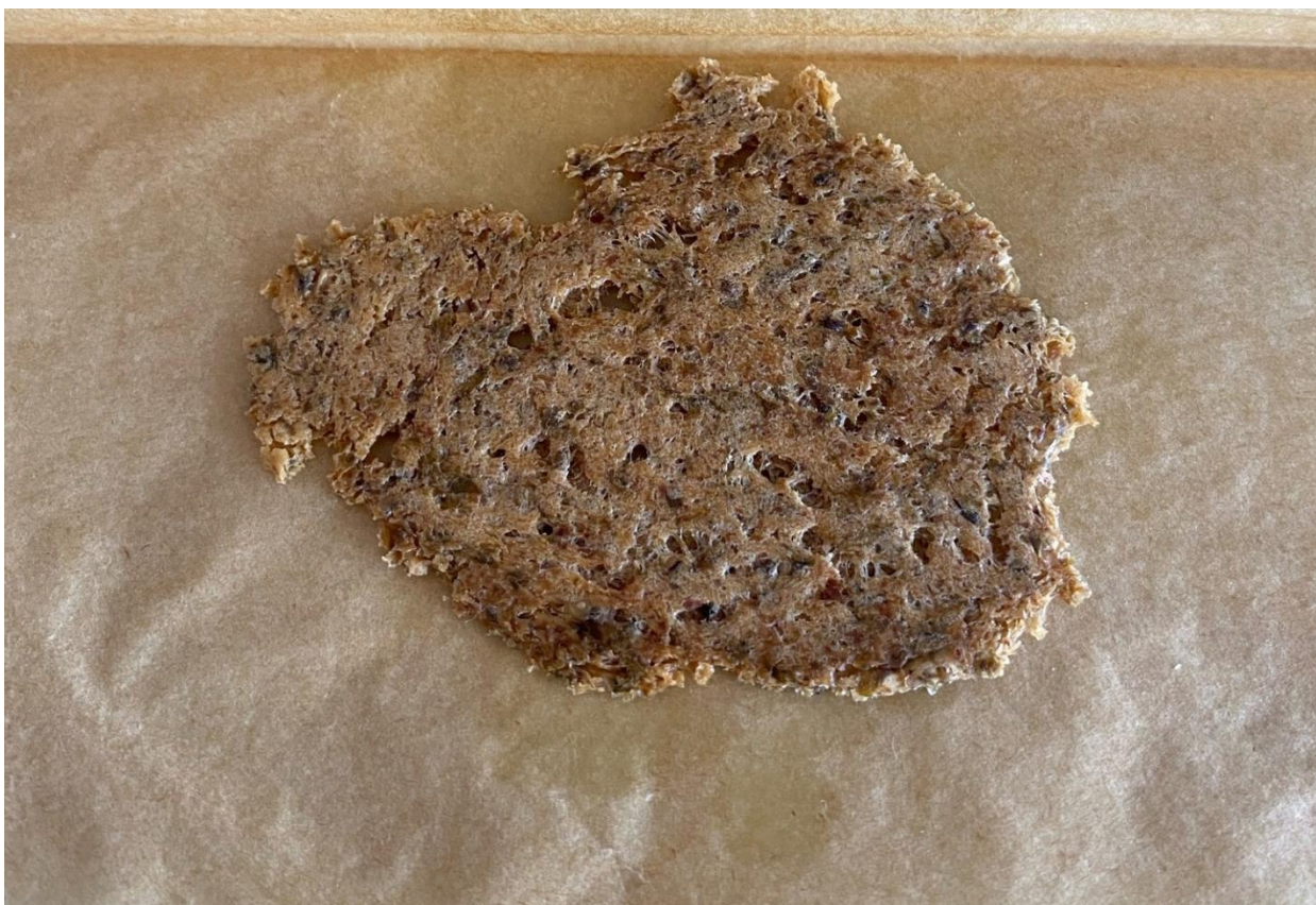
Рисунок И.4 – Анализ на содержание влаги. После высушивания образца хлеба из пшеничной муки
