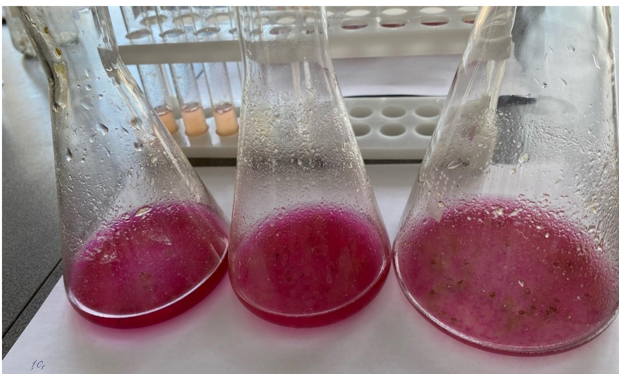
Рисунок Ж.5 – Результат титрования образца джема с добавлением 1,0 грамма аскорбиновой кислоты
