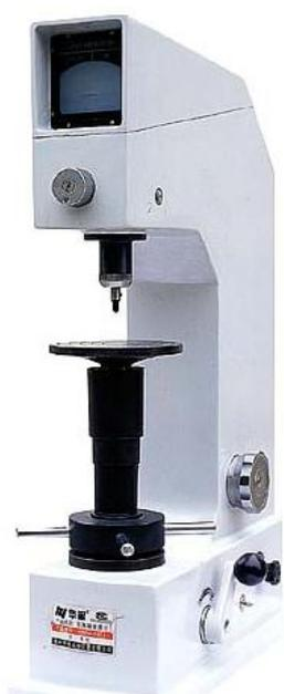
Рисунок 2.9 – Универсальный твердомер HBRV – 187.5
