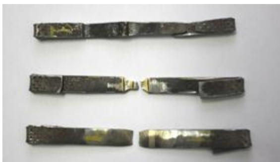
Рисунок 3.7 - Образцы для испытания сварных соединений на статическое растяжение
