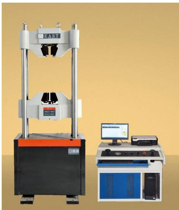
Рисунок 2.6 - Универсальная испытательная машина WAW-1000
