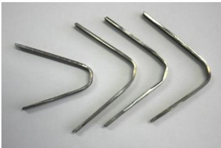
Рисунок 2.8 - Образцы после испытаний сварных соединений на статический изгиб
