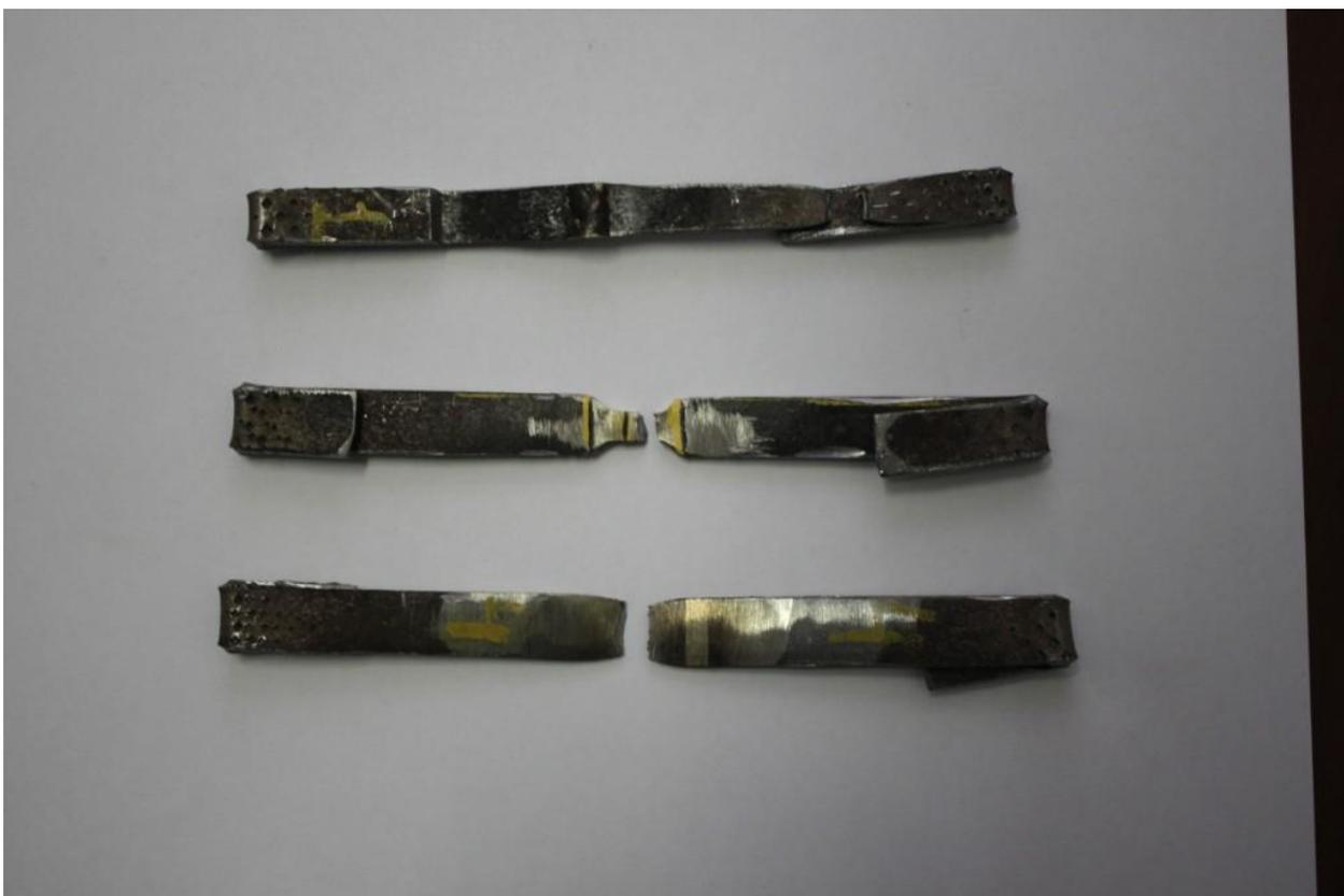
Рисунок 2.7 – Три типа образцов для испытаний на статическое растяжение
