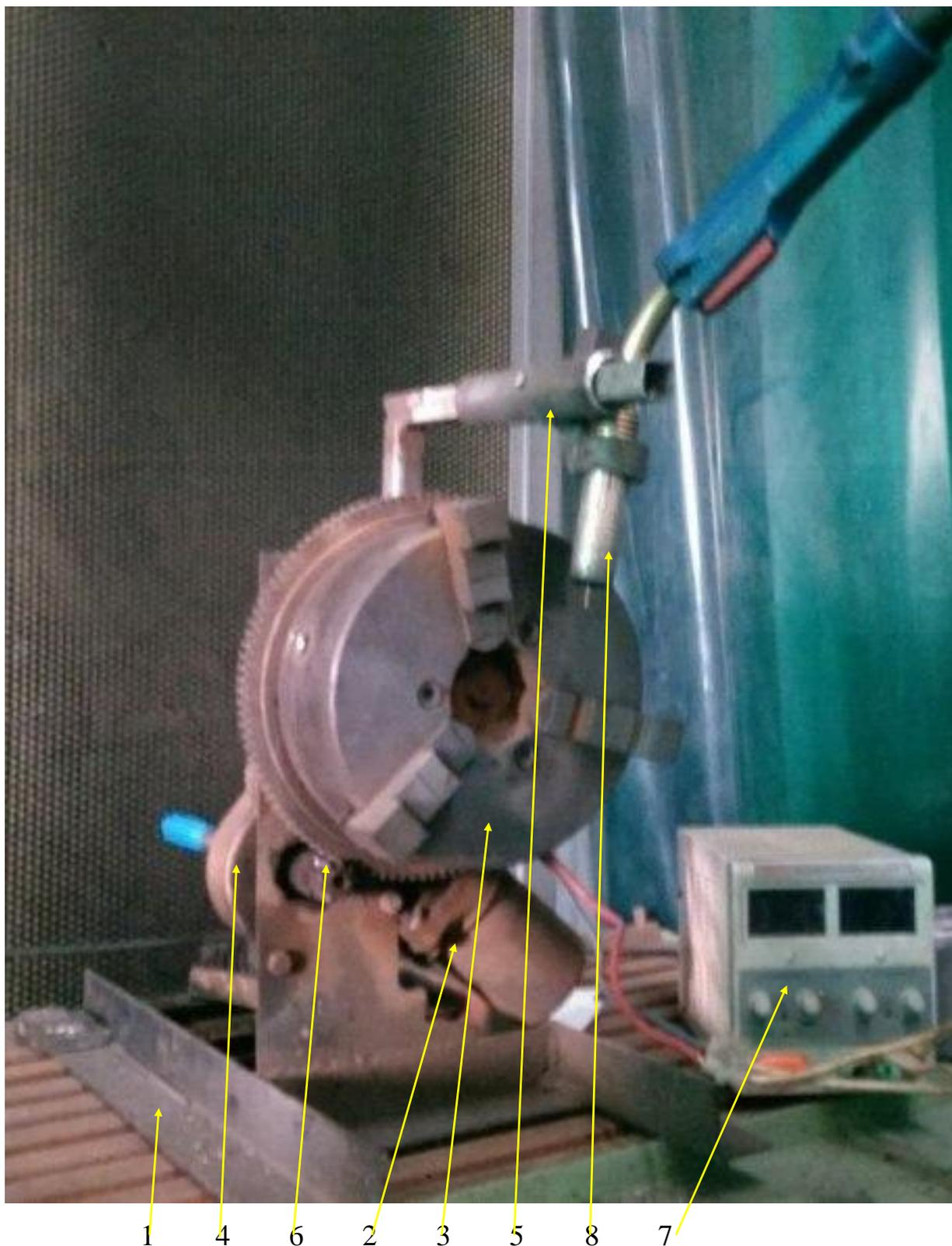
Рисунок 2.1 - Установка для полуавтоматической сварки в среде защитных газов
