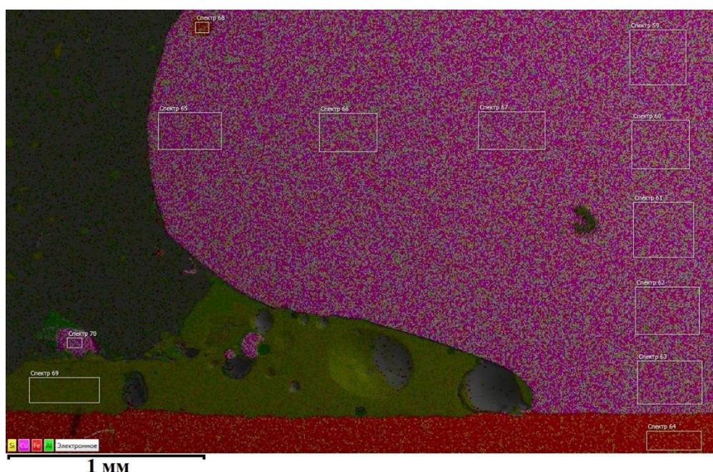
Рисунок 3.4 – Граница металла шва, основного металла и силикатно-эмалевого покрытия
