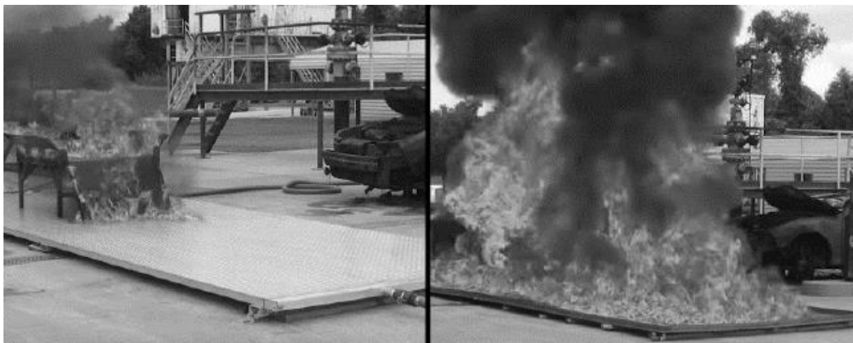
Рисунок 10 – Испытания модульных поддонов в виде противопожарного настила. Слева – горение пролива керосина в модульном поддоне, справа – горение пролива керосина в открытом поддоне
