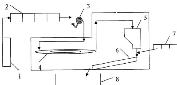
«1 – устройство для приготовления и распыления раствора реагента, 2 – устройство для приготовления и распыления анодного раствора флокулянта, 3 – подъемный кран, 4 – скребковый конвейер, 5 – бункер-накопитель, 6 – транспортный конвейер, 7 – устройство для приготовления и распыления катодного раствора флокулянта, 8 – котлован-могильник» [35]
