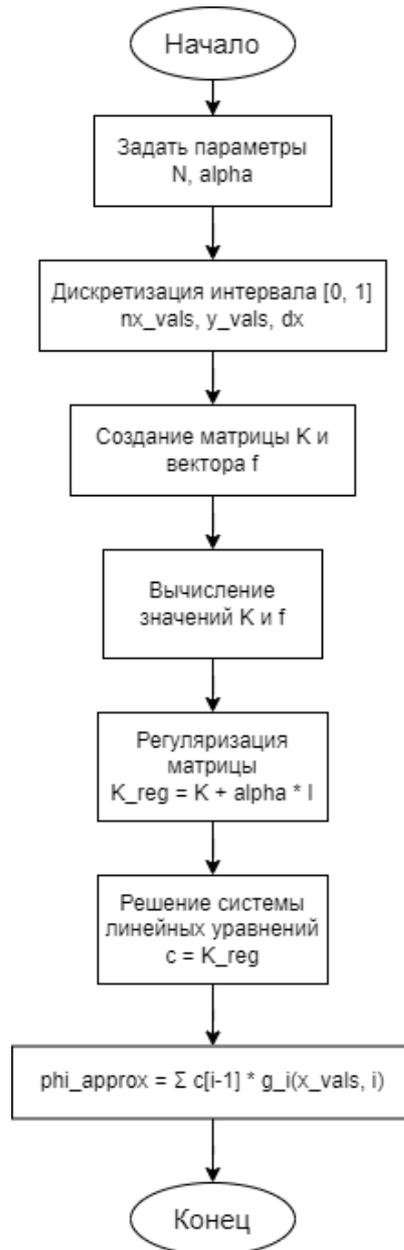
Рисунок 2 – Блок-схема работы численного метода аппроксимации ядра
