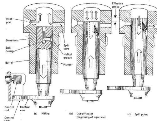
Рисунок 14 – Взаимодействие поршня с управляющими отверстиями в цилиндре
