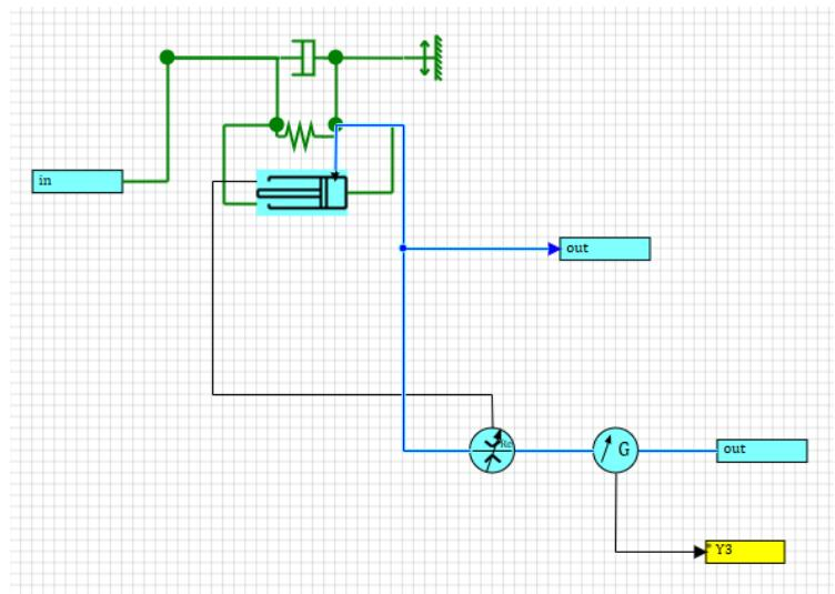
Рисунок 15 – Программная модель форсунки на базе SimInTech
