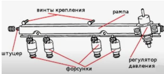
Рисунок 4 – Топливная рампа
