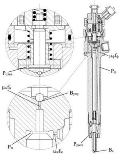
Рисунок 7 – Расчетная схема форсунки с электромагнитным управлением
