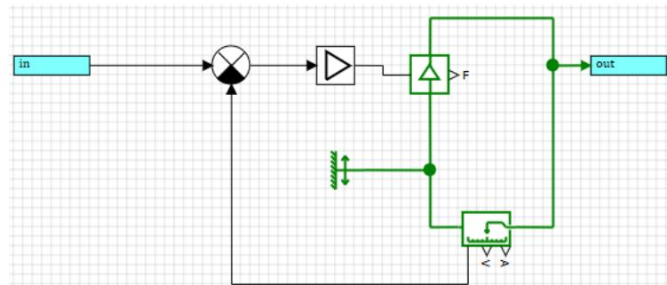
Рисунок 11 – Программная модель блока источника позиционирования на базе SimInTech
