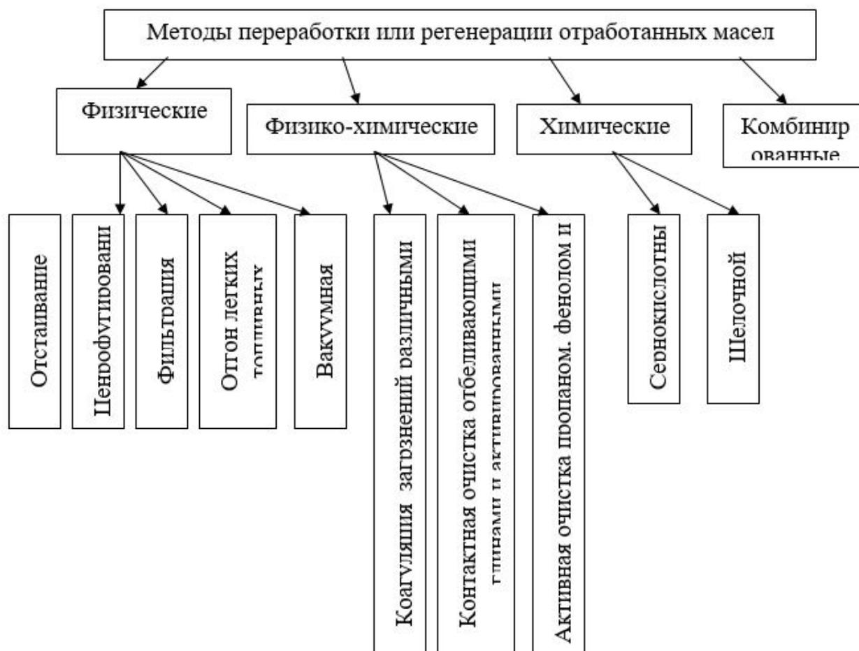
Рисунок 18 - Методы переработки или регенерации отработанных масел
