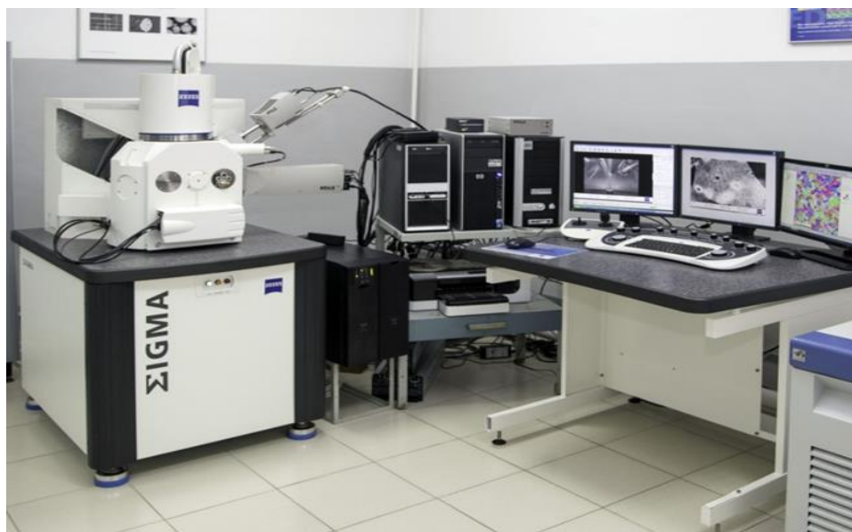
Рисунок 15 – Сканирующий электронный микроскоп «Carl Zeiss Sigma»
