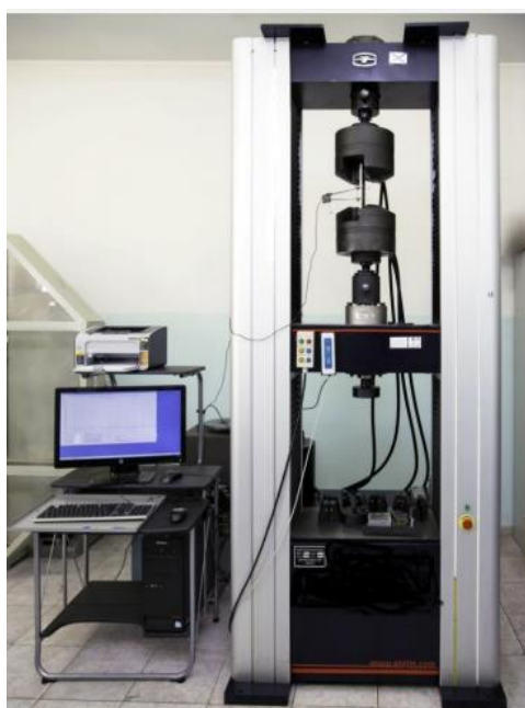
Рисунок 10 - Испытательная машина H50КТ, с компьютерным управлением
