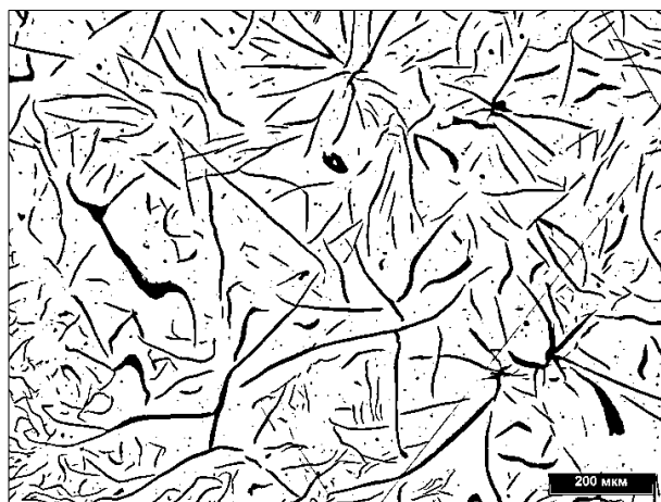
Рисунок 9 – Размер и распределение графита на тормозном диске 3. Зона вырезки образца 90^\circ относительно питателя
