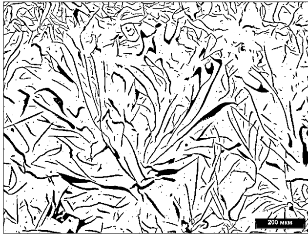
Рисунок 11 – Размер и распределение графита на тормозном диске 4. Зона вырезки образца 90° относительно питателя
