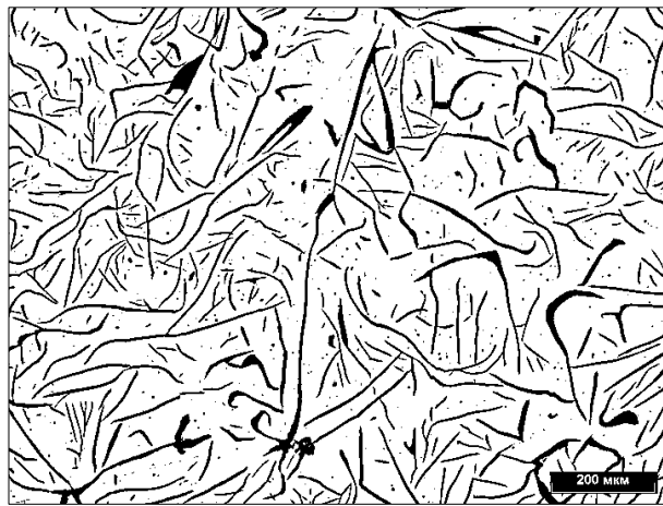
Рисунок 8 – Размер и распределение графита на тормозном диске 3. Зона вырезки образца со стороны питателя
