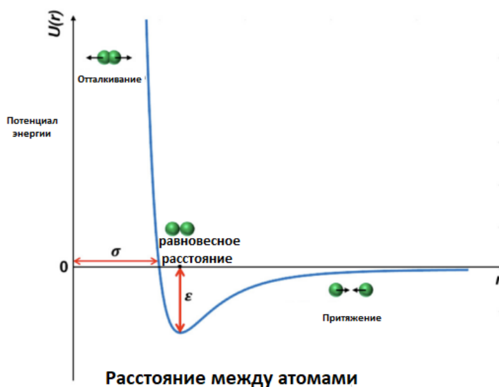
Рисунок 2 - Межатомная потенциальная энергия ( U_r ) в зависимости от расстояния между двумя соседними атомами
