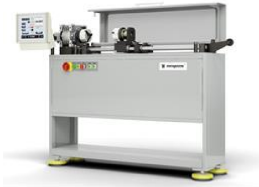
Рисунок 8 - Машина КТС-405-20-0.5 для испытания образцов на кручение
