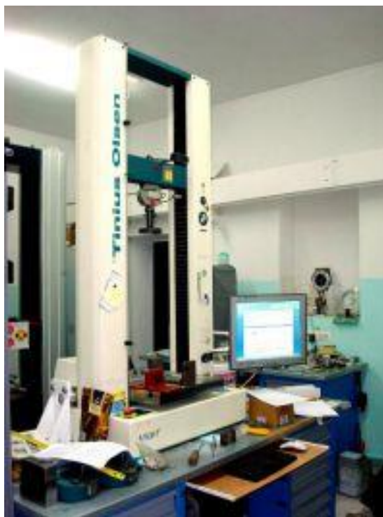
Рисунок 7 - Универсальная испытательная машина Н50КТ, с компьютерным управлением предназначена для определения механических свойств материалов
