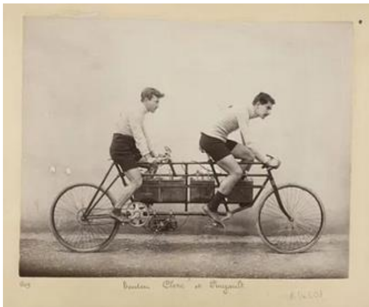
Рисунок 3 – Конструкция электрического тандем
