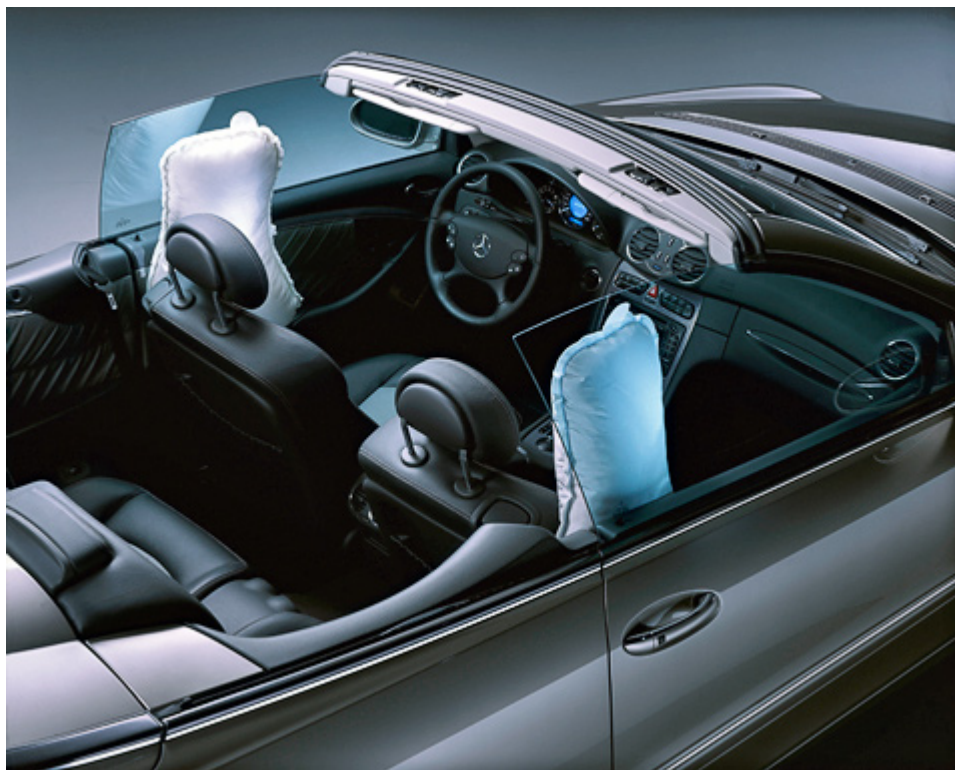
Рисунок 6 – Установка подушек безопасности в двери автомобиля
