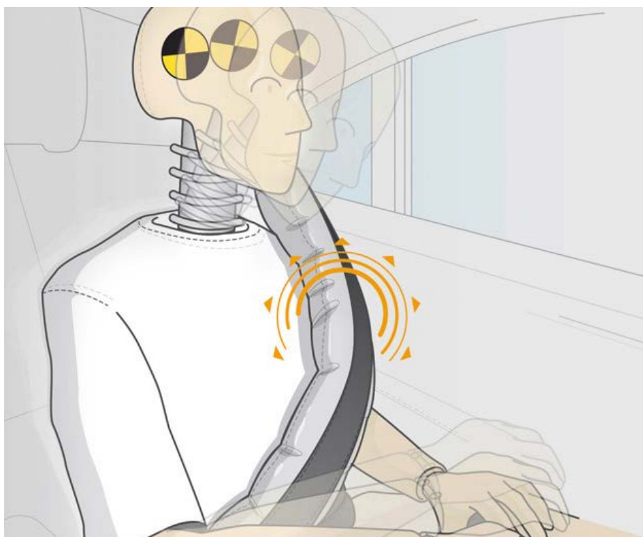
Рисунок 9 – Демонстрация срабатывания надувного ремня безопасности
