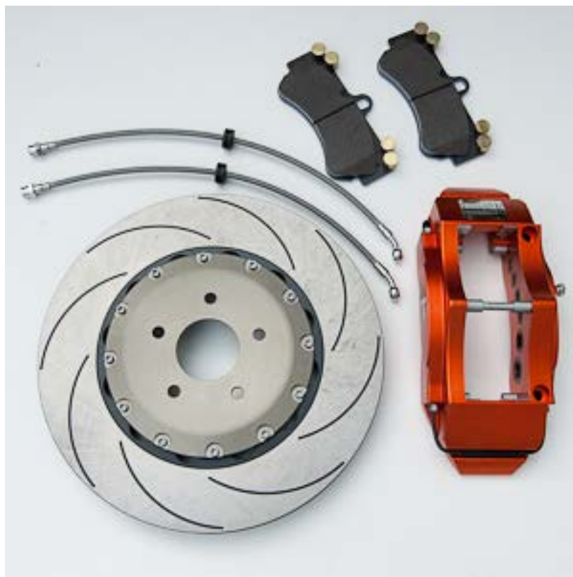
Рисунок 4 – Передний тормозной суппорт для замены штатного узла
