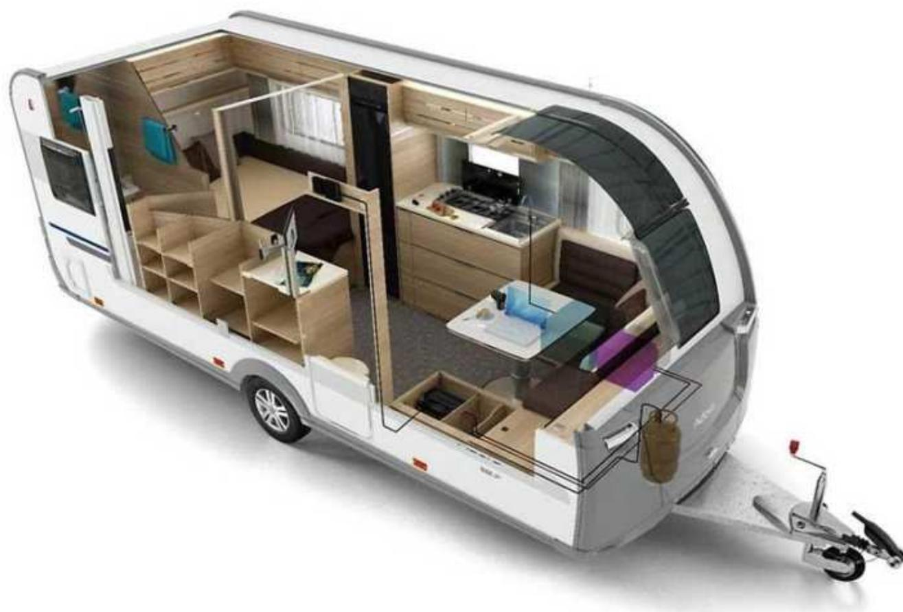
Рисунок 7 – Одноосный автодом в разрезе
