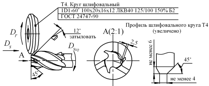
Рис. 9.7. Шлифование большого зуба на четвертом переходе
