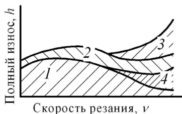
Рис. 8.5. Обобщенная зависимость полного износа от скорости резания: 1 – адгезионный износ; 2 – абразивный износ; 3 – диффузионный износ; 4 – окислительный износ
